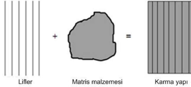
Şekil 2.1: Reçine ve takviyeden oluşan karma yapı [21].
