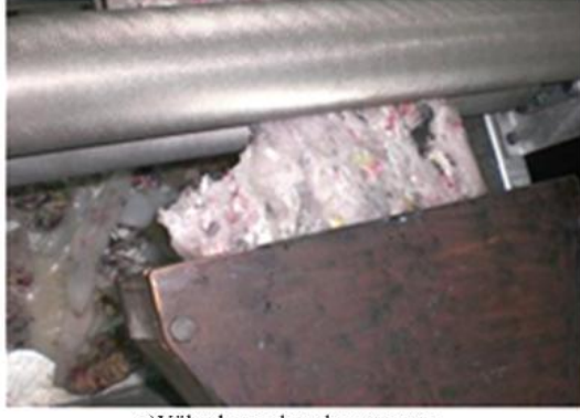
a)Yüksek merdane hızı sonucu kopma
