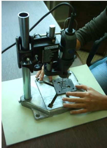
Şekil 5.14. Delme ve yiv açma işlemlerinin gerçekleştirildiği el matkabı.
