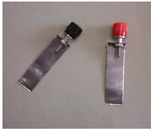
Şekil 5.15. Soket yuvalarına tutturulmuş metal folyolar.
