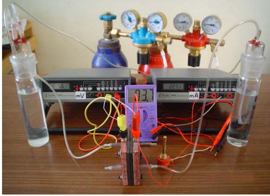
Şekil 5.26. Çalıştırılan hidrojen/oksijen beslemeli proton değişim zarlı yakıt hücresinin fotoğrafı.
