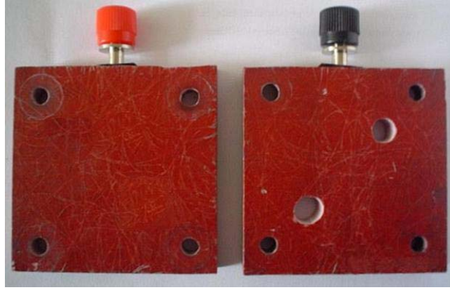
Şekil 5.17. Hidrojen/hava beslemeli proton değişim zarlı yakıt hücresi tutucuları.
