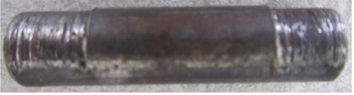
c) 3000 N luk yük ve 375 m lik kayma mesafesi sonrası oluşan aşınma
