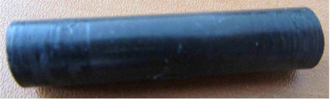
a) 1000 N luk yük ve 375 m lik kayma mesafesi sonrası oluşan aşınma
