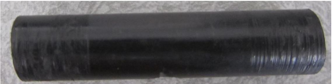
c) 3000 N luk yük ve 375 m lik kayma mesafesi sonrası oluşan aşınma
