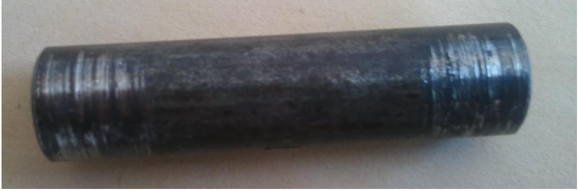
a) 1000 N luk yük ve 375 m lik kayma mesafesi sonrası oluşan aşınma
