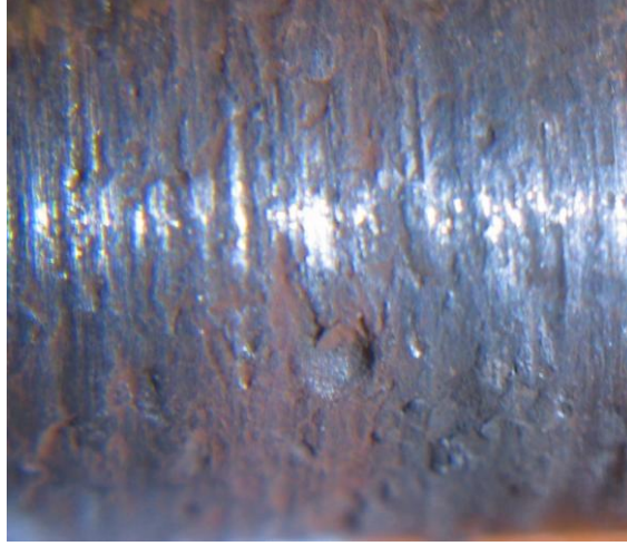
c) 3000 N luk yük ve 375 m lik kayma mesafesi sonrası oluşan aşınma
