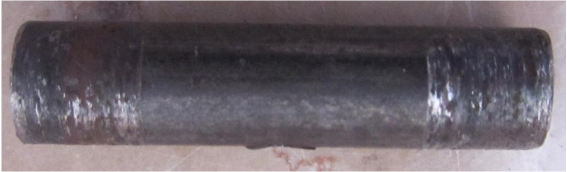
b) 2000 N luk yük ve 375 m lik kayma mesafesi sonrası oluşan aşınma
