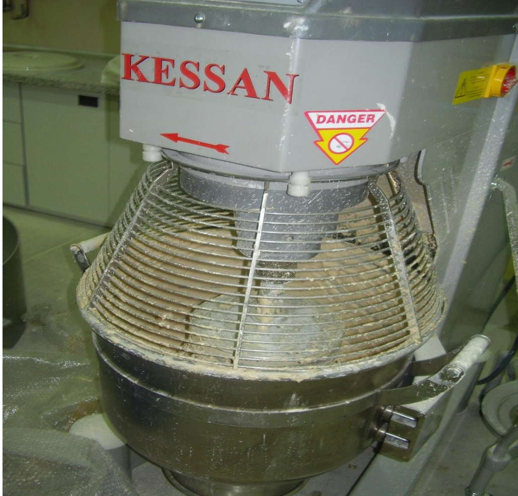
Şekil 5.9 Mikser içerisinde hazırlanan zemin numunesi
