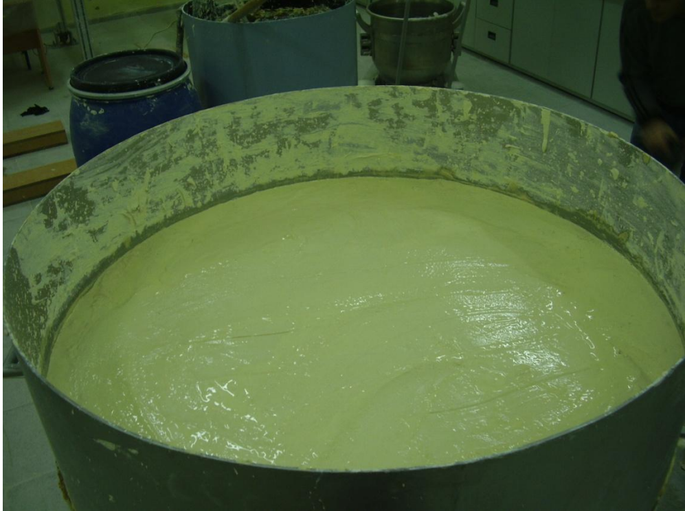
Şekil 5.12 Tankın 105 cm yüksekliğine kadar doldurulan zemin
