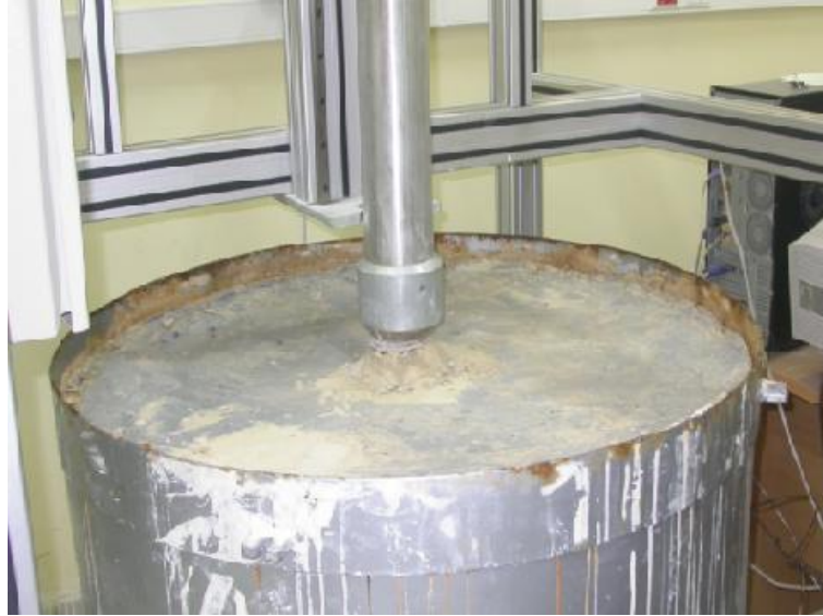
Şekil 5.18 Model deney tankında DTK üretimine başlamadan önceki görünüş
