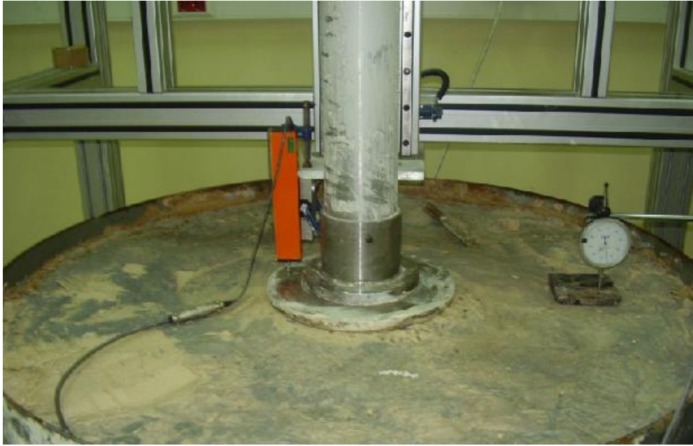
Şekil 5.22 Yükleme plakasının ve deplasman ölçerinin yerleşimi
