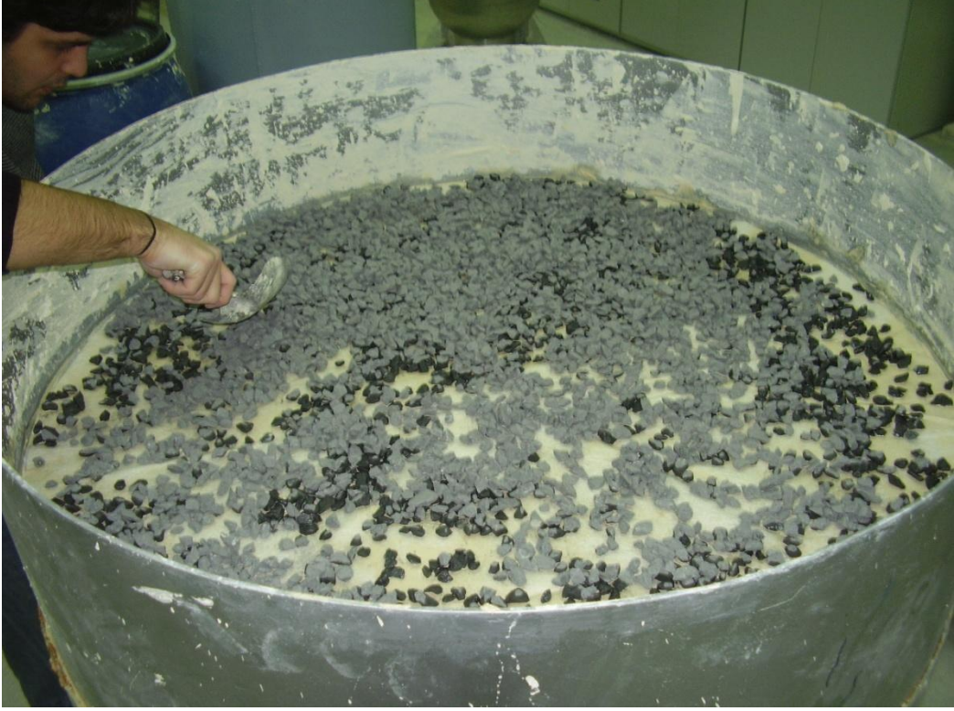
Şekil 5.13 Hazırlanan zemin numunesine geotekstil ve çakıl serilmesi.
