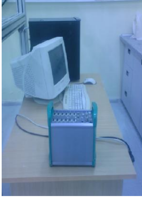
Şekil 5.6 imcStudio veri toplama cihazı
