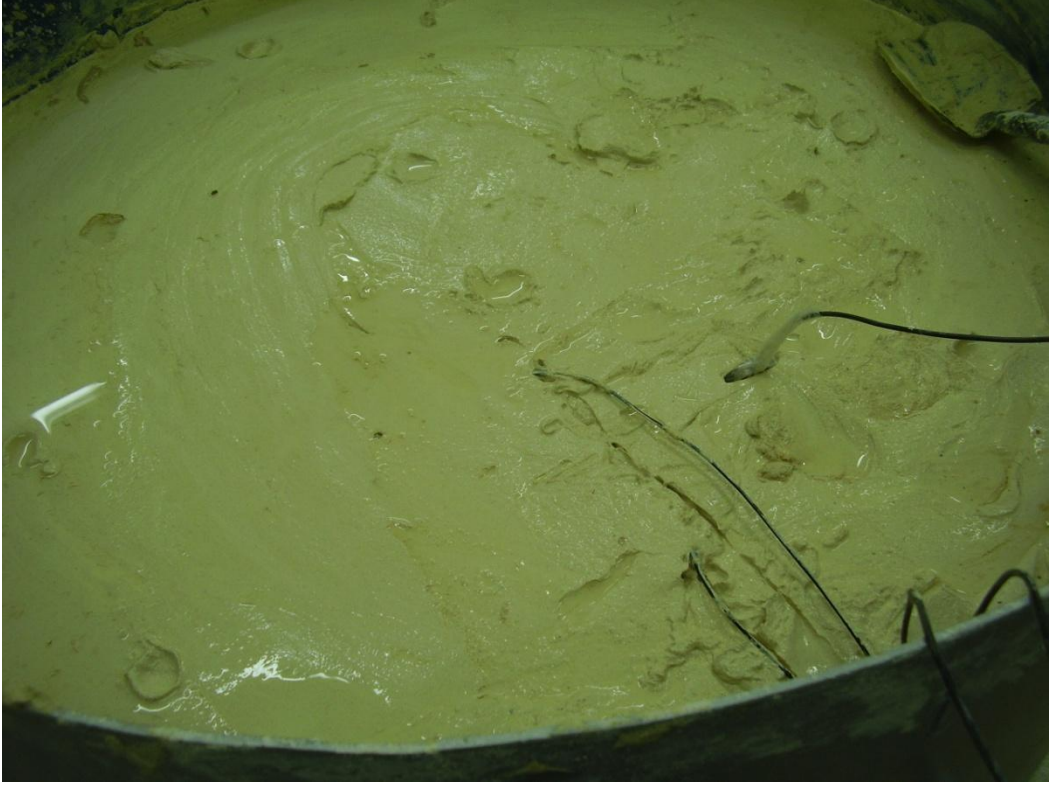
Şekil 5.11 75 cm seviyesinde tankın içine yerleştirilen sensörler.
