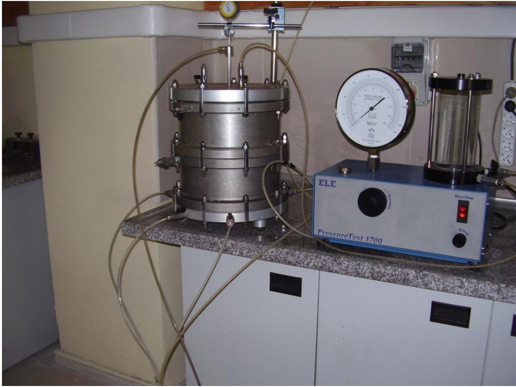
Şekil 4.4 Rowe hücresi ve konsolidasyon deneyi
