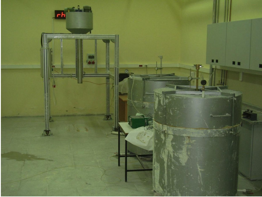
Şekil 5.15 Üstü kapatılıp, düşey deplasman ölçerler yerleştirilen tanklar.
