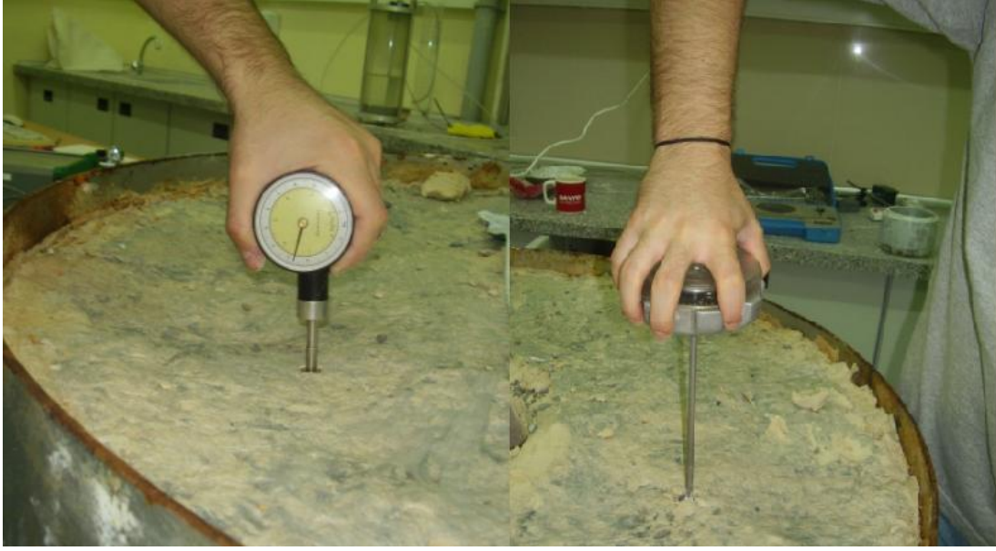
Şekil 5.17 Cep penetrometresi ve veyn ölçümleri.
