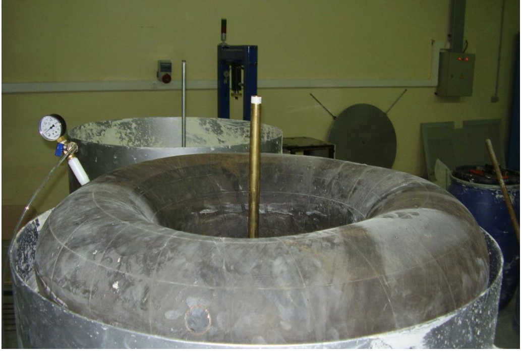
Şekil 5.14 Tank içine yerleştirilen hava yastığı
