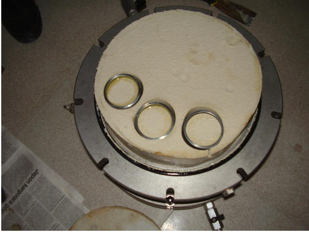
Şekil 4.8 Rowe Hücresinden üç eksenli deneyi için numune alımı
