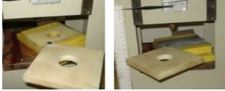
Şekil III.19: Sacın Deney Düzeneğine Yerleşimi
