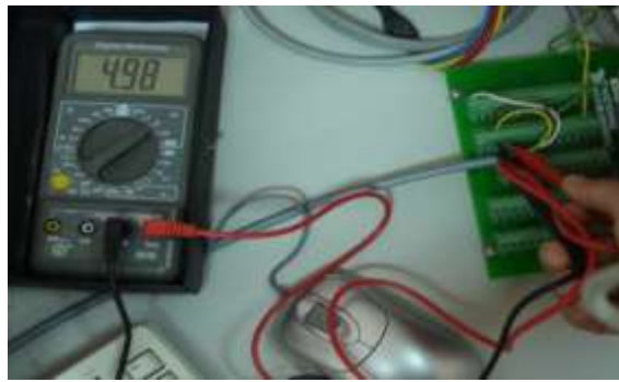
Şekil III.15: Analog Çıkıştan Okunan Voltaj Değeri
