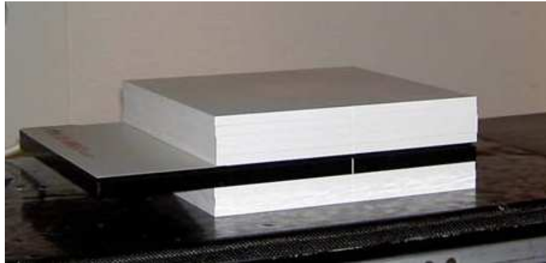
Şekil 3.19 Seven29 sistemi'nin tomografi görüntüsünün alınması için RW3 plakaları ile kullanımı
