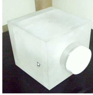
Şekil 2.65 Düşük maliyetli IMRT fantomu, Jel dozimetre kabının yerleştirileceği bölüm gösterilmektedir.
