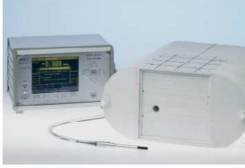
Şekil 2.74 Mutlak doz doğrulama için fantomun kübik modüler kısmı içine farklı tipteki iyon odalarının yerleştirilmesi
