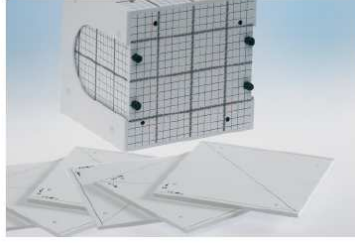
Şekil 2.73 Fantomun CT içinde kolayca ayarlanabilmesini sağlayan renkli markerlar
