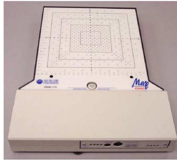
Şekil 2.32 Background ve kalibrasyon için Mapcheck’in konumu (Mapcheck user manuel)
