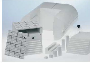
Şekil 2.71 IMRT fantomunun baş ve boyun ile stereotaktik uygulamalar için modüler tasarımı
