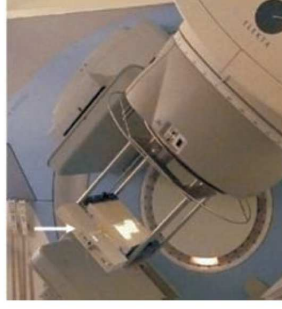
Şekil 2.93 Diyod dizilerinin yerleştirildiği kol tüm gantri dönüşü için tek tek alanların ölçümüne izin verir.
