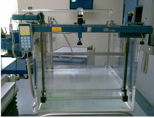
Şekil 3.6 Su fantomunun Elekta marka Synergy model lineer hızlandırıcı ile kullanılması
