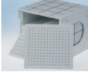
Şekil 2.75 TLD plakasının tek ya da film ile birleştirilerek fantomun kübik modüler kısmına yerleştirilmesi
