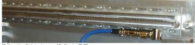
Şekil 2.25 Precision 2D CT için kullanılan 80 Mikron doğrusal dedektör dizisi
