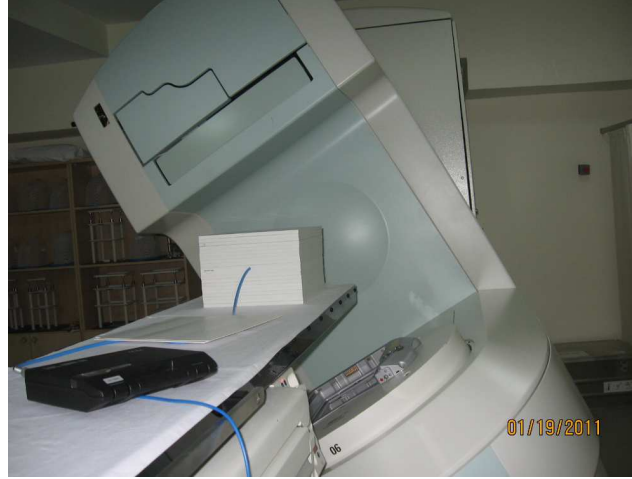
Şekil 3.18 İyon odası ile hasta dozimetri kontrolünde fantom görüntüsü
