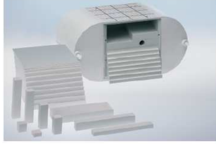
Şekil 2.72 IMRT fantomunun içinde vücudun genel yapısına ait kesitler vardır. Küp fantom kısmı torso içine yerleştirildiğinde orijinal antropomorfik şekil alır.
