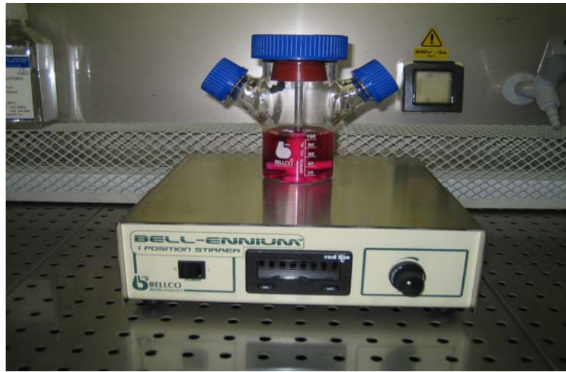
Şekil 3.3. Dinamik kültür çalışmalarının yürütüldüğü karıştırmalı reaktör (spinner flask) sistemi.
