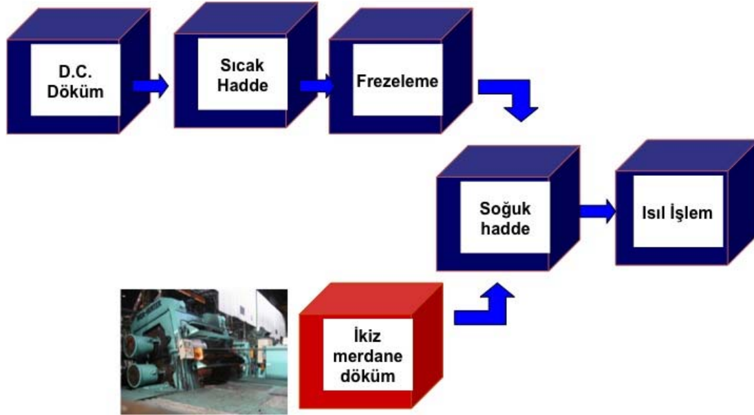
Şekil 2.13: DS ve İMD yöntemlerinin akış şemalarının karşılaştırması
