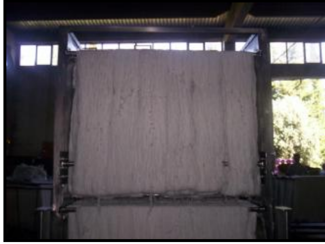
Şekil 3.3. Çilelerin Kazanlara Yerleştirilmesi(Ulusoy Tekstil, 2009)
