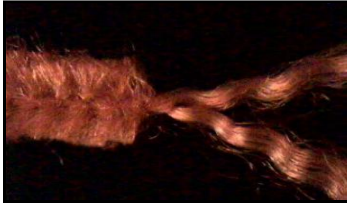
Şekil 1.6. Şönil İpliğinin Havları Sıyrılmış Haldeki Görünümü (İlhan, 2004)
