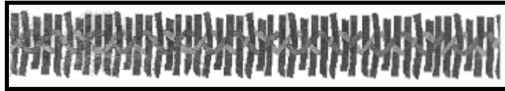
Şekil 1.2. Şönil İplik Yapısının Şematik Görünümü (Erem,2006)
