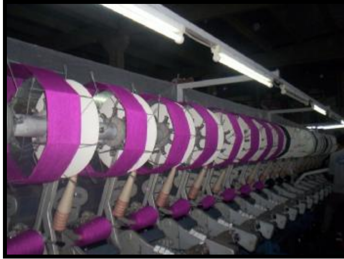
Şekil 3.6. Kurutulan Çilelerin Bobinlere Aktarılması (Ulusoy Tekstil, 2009).
