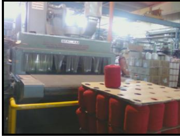
Şekil 3.9. Bobin Kurutma Makinesi (Ulusoy Tekstil, 2009)
