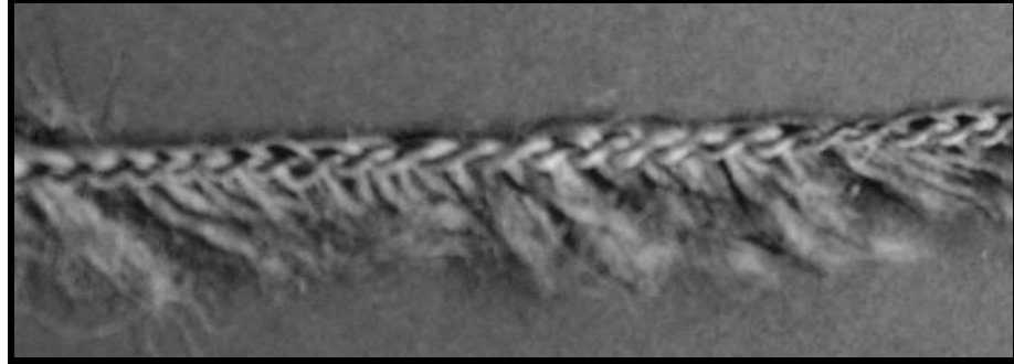
Şekil 1.11. Örme Tekniği İle Elde Edilmiş Tüylü Şönil İplik (İlhan, 2004)
