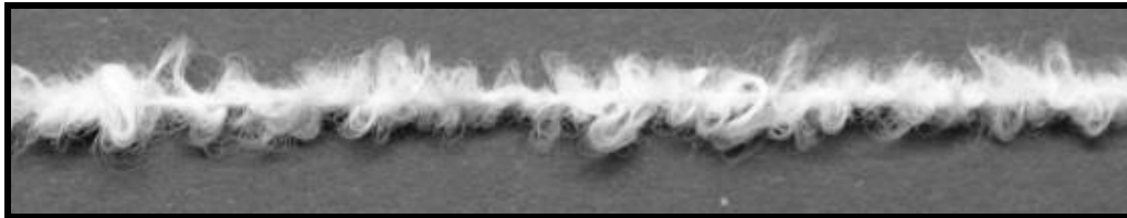
Şekil 1.10. Hava Jeti İle Tekstüre Edilmiş Şönil Taklidi İplik (İlhan, 2004)
