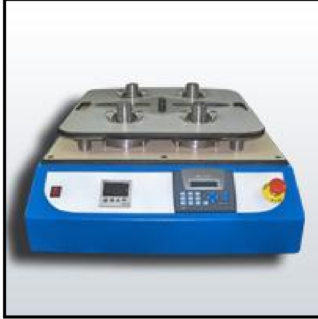
Şekil 3.17. Martindale Boncuklanma Test Cihazı ( www.aygenteks.com ,2011)
