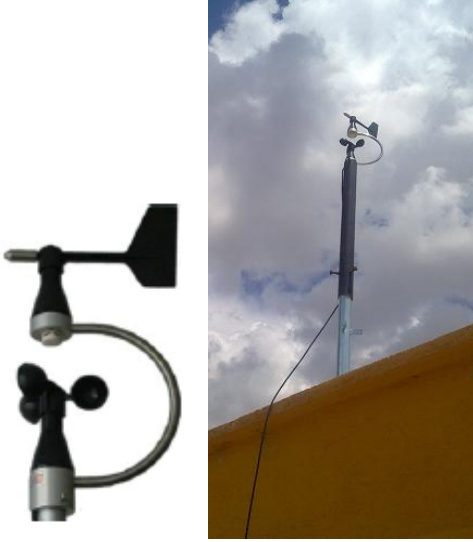
Şekil 3.12. Anemometrenin görüntüsü ve teknik özellikleri
