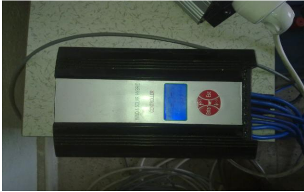
Şekil 3.17. Hibrit şarj kontrol cihazı ve teknik özellikleri.
