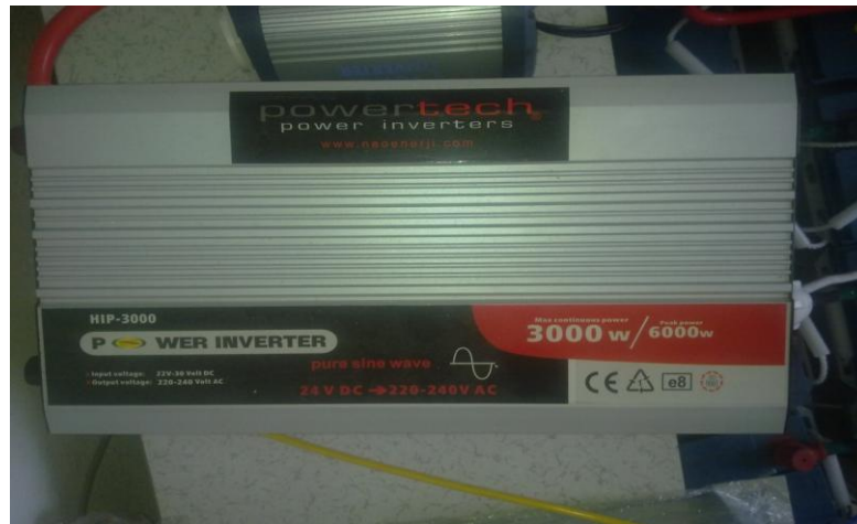
Şekil 3.20. Sistemde kullanılan inverter.
