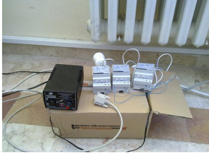
Şekil 3.34. Akım ve gerilim datalogeri.
