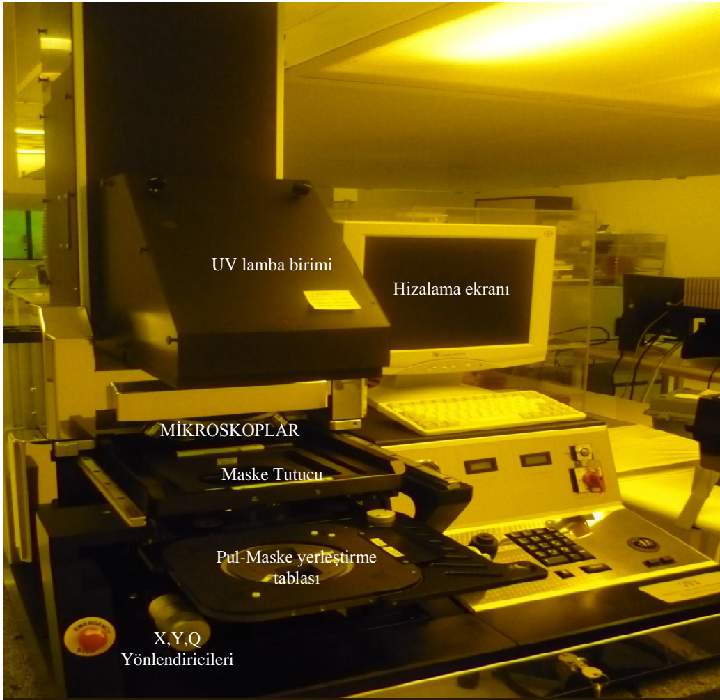
Şekil 3.5 Maske Hizalayıcı cihazı
