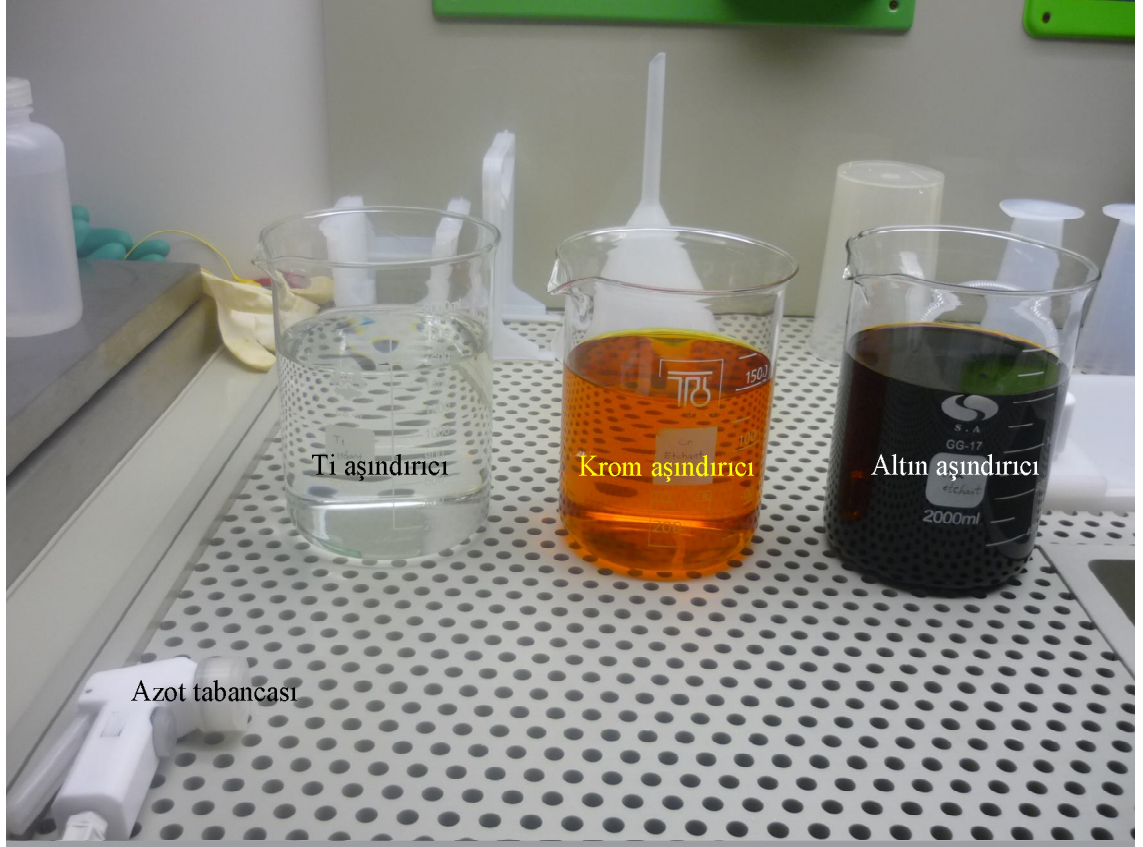
Şekil 3.2 Islak aşındırma sürecinde kullanılan aşındırıcılar ve tezgah
