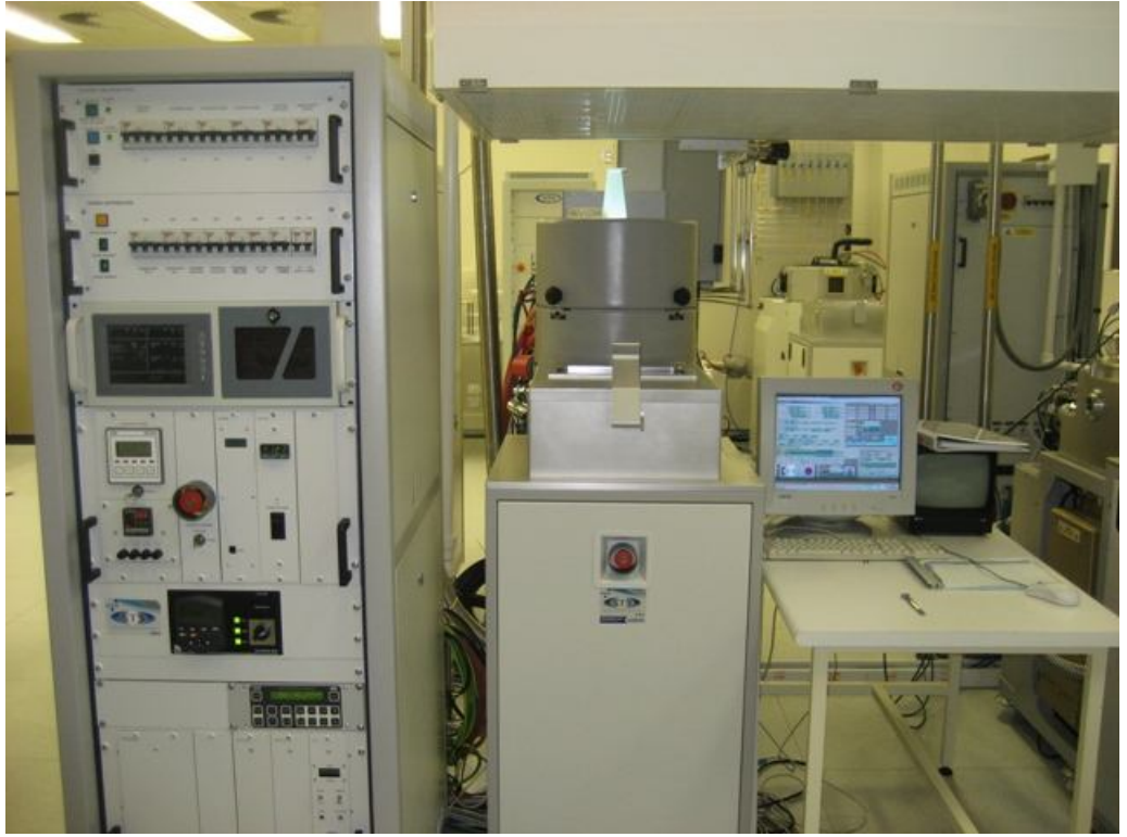
Şekil 3.8 Silisyum tabanda derin kuyuların oluşturulmasında kullanılan DRIE cihazı
