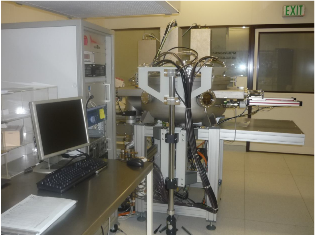
Şekil 3.1 ODTÜ MEMS Merkezinde kullanılan Tozutmaya cihazı
