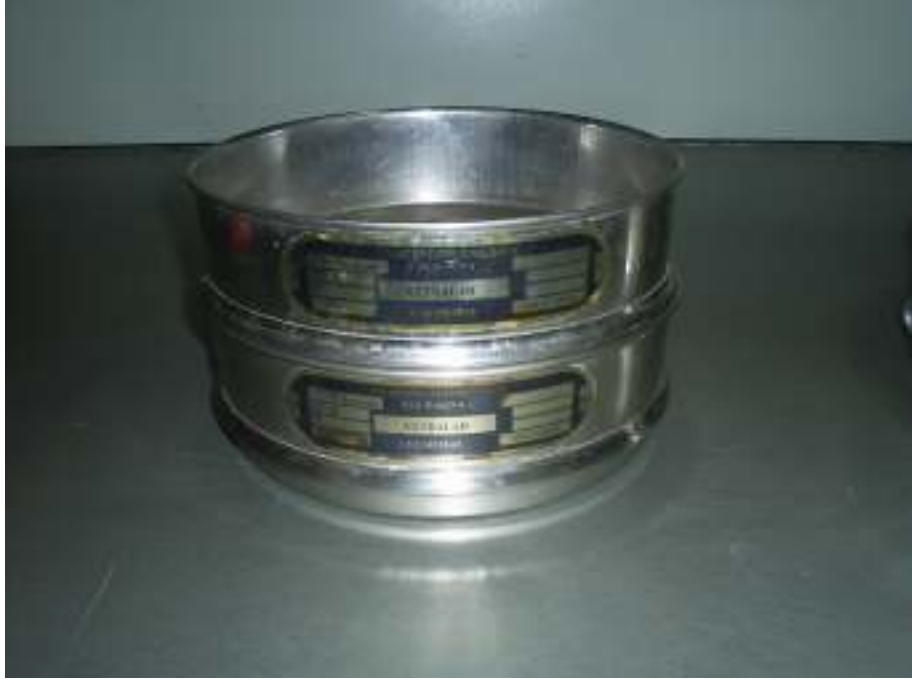
Şekil 5.4 Mangan Oksit Mineralinin Elenmesinde Kullanılan Elekler
