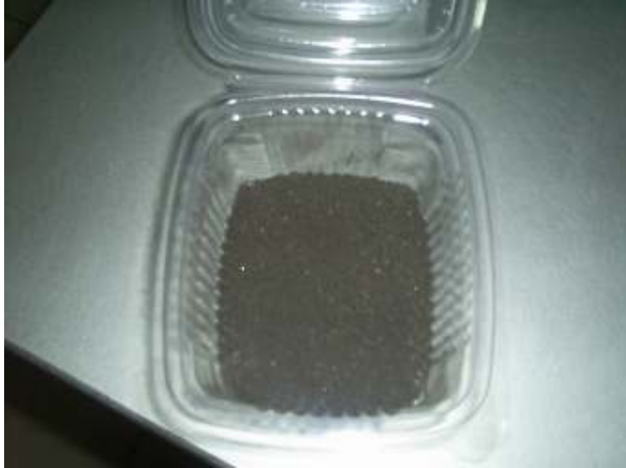
Şekil 5.3 Mangan Oksit Mineralinin Elekten Geçirilmiş Görünümü
