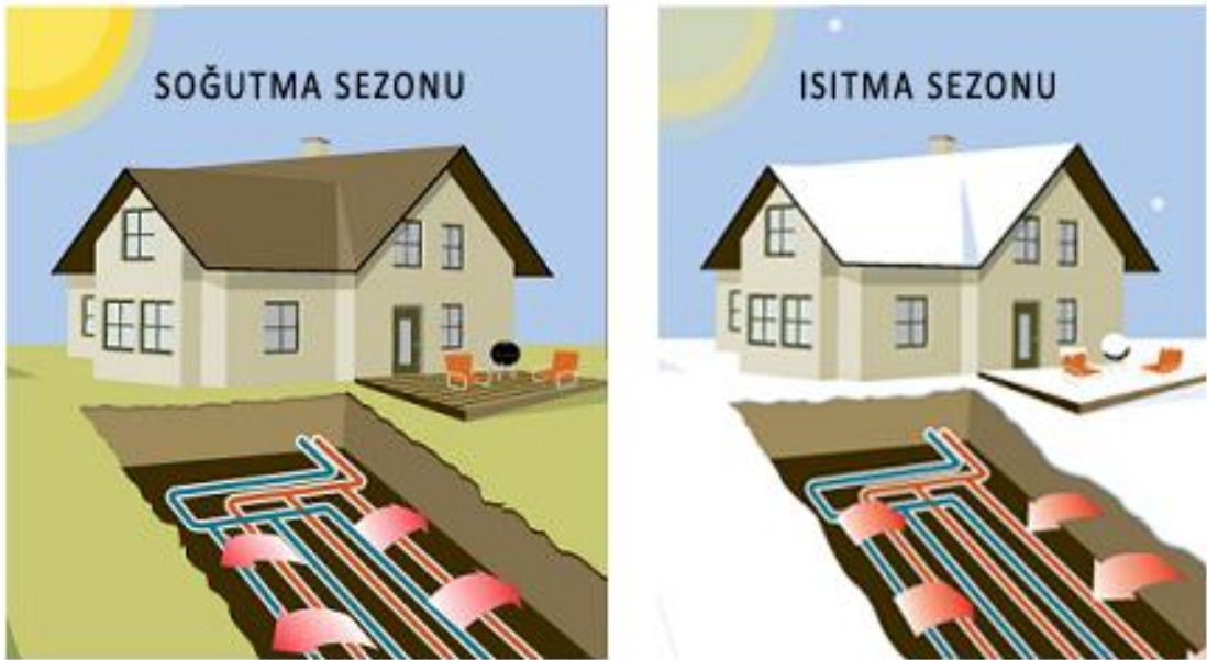
Şekil 3.3 Toprak altı devresinin toprakla yaptığı ısı alışverişi
