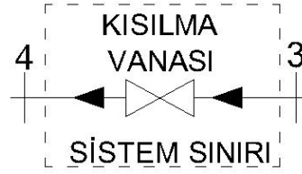
Şekil 6.11 Kısılma vanası sistem şeması
