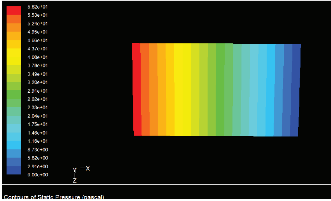
Şekil 3.7 : u_m = 0,002988 m/s sınır şartı için basınç düşümü analizi.
