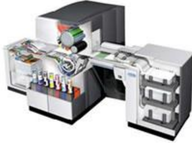
Şekil II.12, Dijital ofset baskı yöntemi çalışma kesiti [16]
