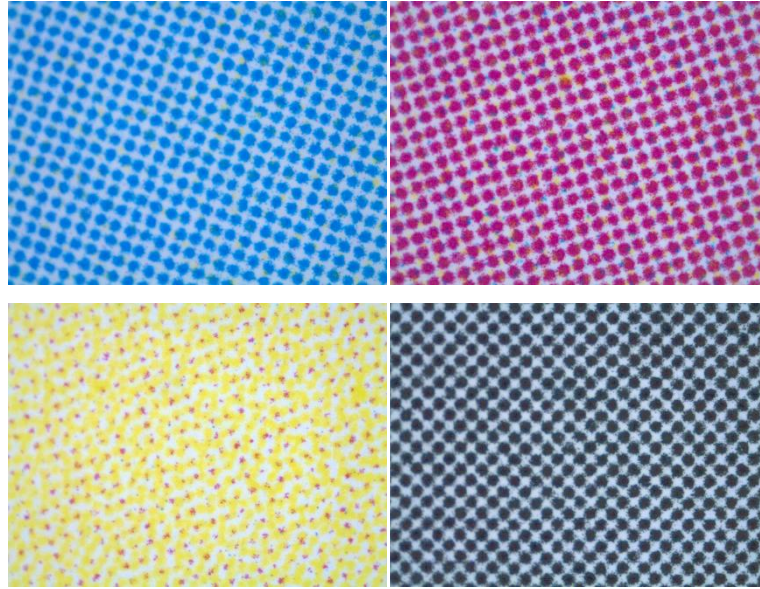
Şekil IV.23: 115g Mat Kuşe %50 Tram değerli CMYK Baskısının İki Yüz Defa Büyütülmüş Hali
