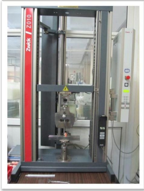
Resim 5.23 : Makaslama Testinin Uygulandıđı Cihaz
