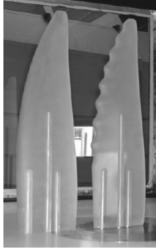
Şekil 3.9 – Prototip iki farklı balina yüzgeci
