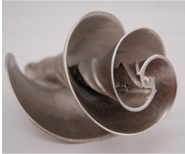
Şekil 3.16 – Su tanklarında kullanılan su mikseri tasarımı
