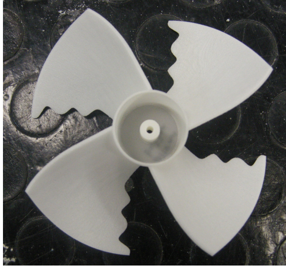
Şekil 5.6 – Deneylerde kullanılacak baykuş fan prototipi
