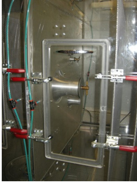
Şekil 4.3 – Tünelin ikinci bölümündeki farklı çaptaki lüleler
