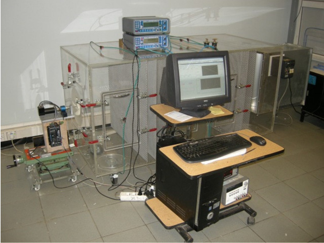
Şekil 5.8 – Fan Karakteristik Eğrisi Ölçülürken
