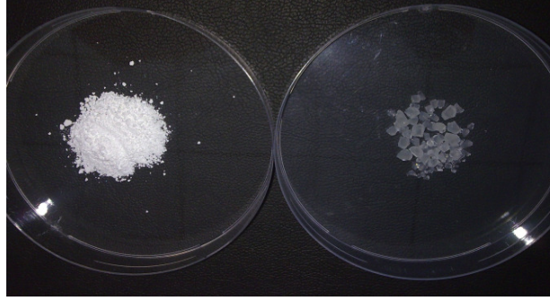
Şekil 4.10. Sodyum salisilatofosfatoborat (solda) ve camlaştırılmış hali (sağda).
