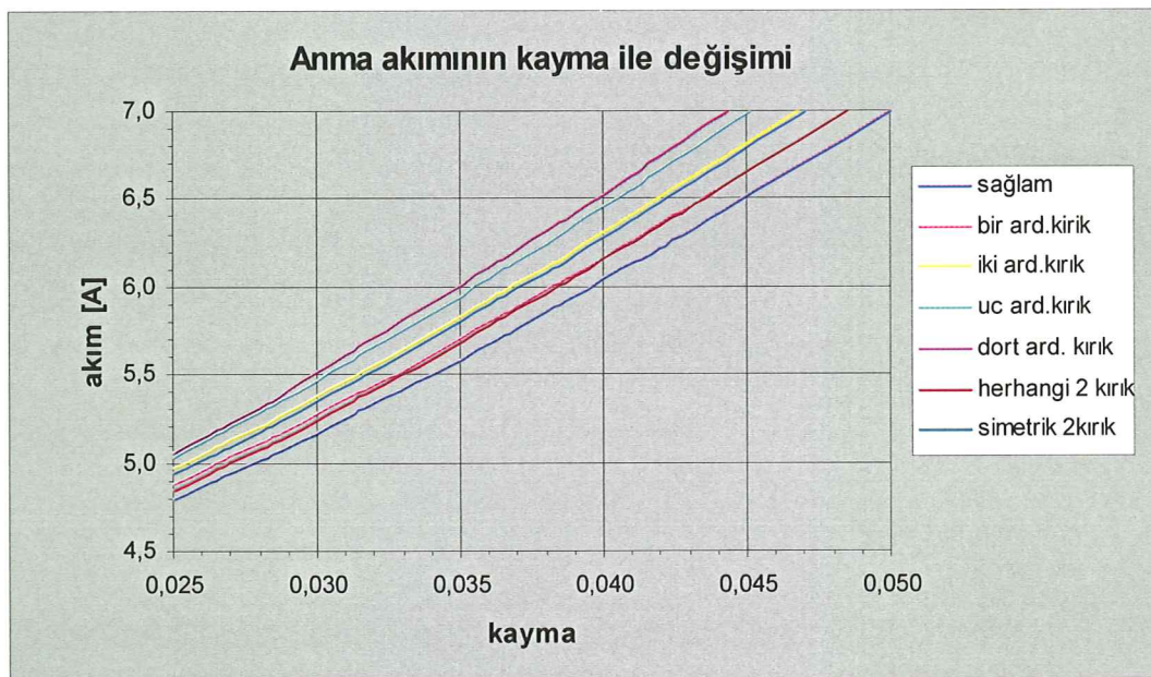
Şekil 5.76 : Anma akımlarının kayma ile değişimi.
