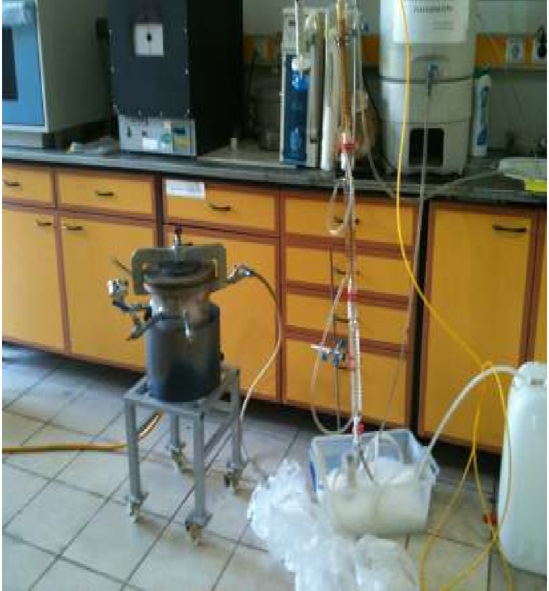
Şekil 5.6 Soğutma Düzeneği ve Soxhlet Eksraktörleri
