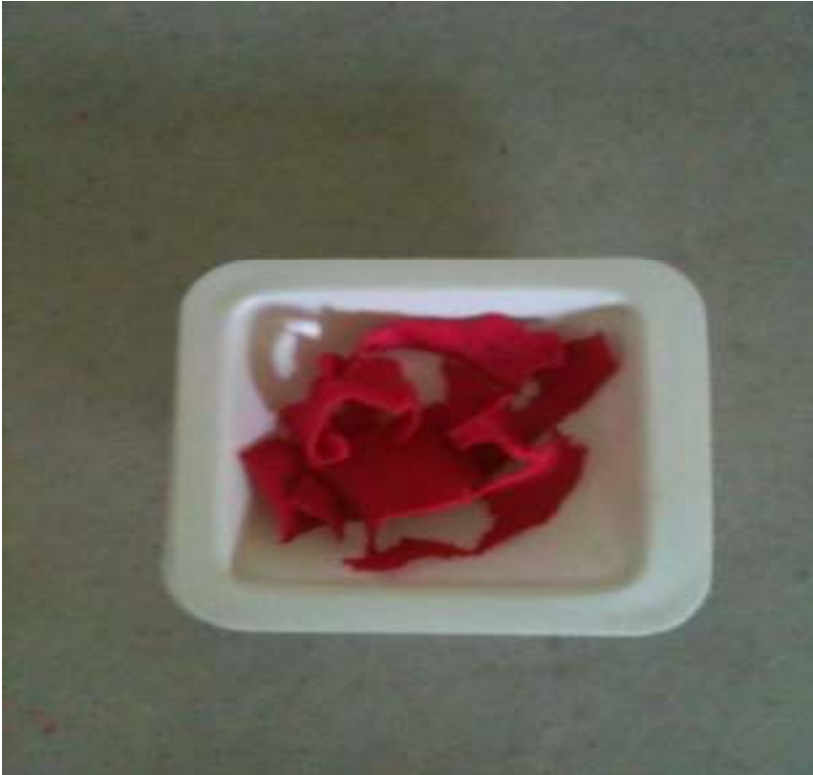
Şekil 5.3 Kalorifik değer hesaplamada kullanılan 0,302 gram numune
