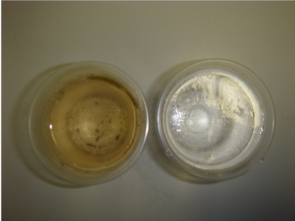
Resim 20. Tank giriş (Solda) ve çıkış numuneleri-02
