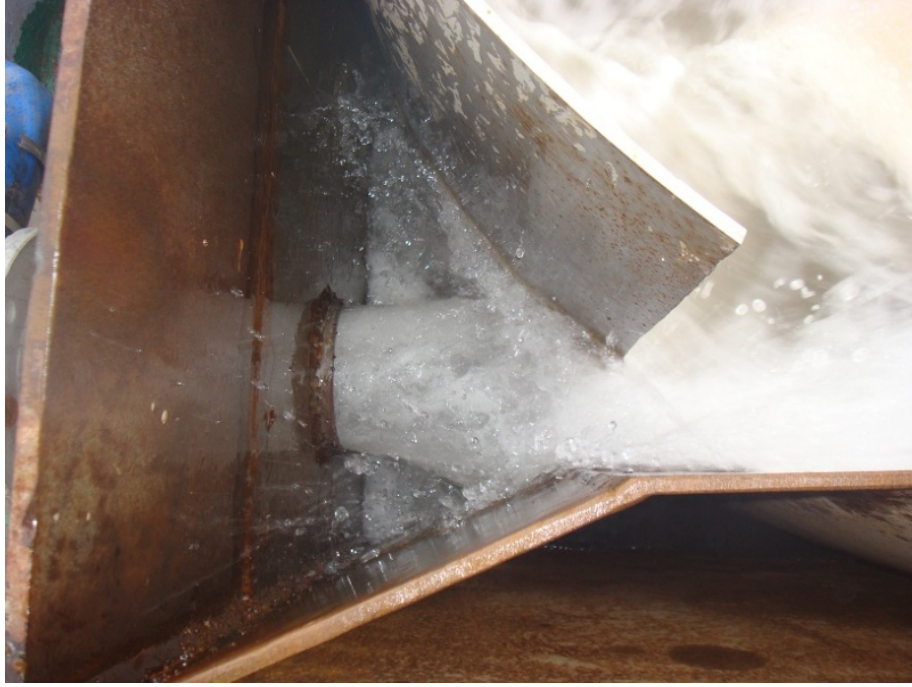
Resim 14. Hız arttırıcı kesit (Üstten görünüş)
