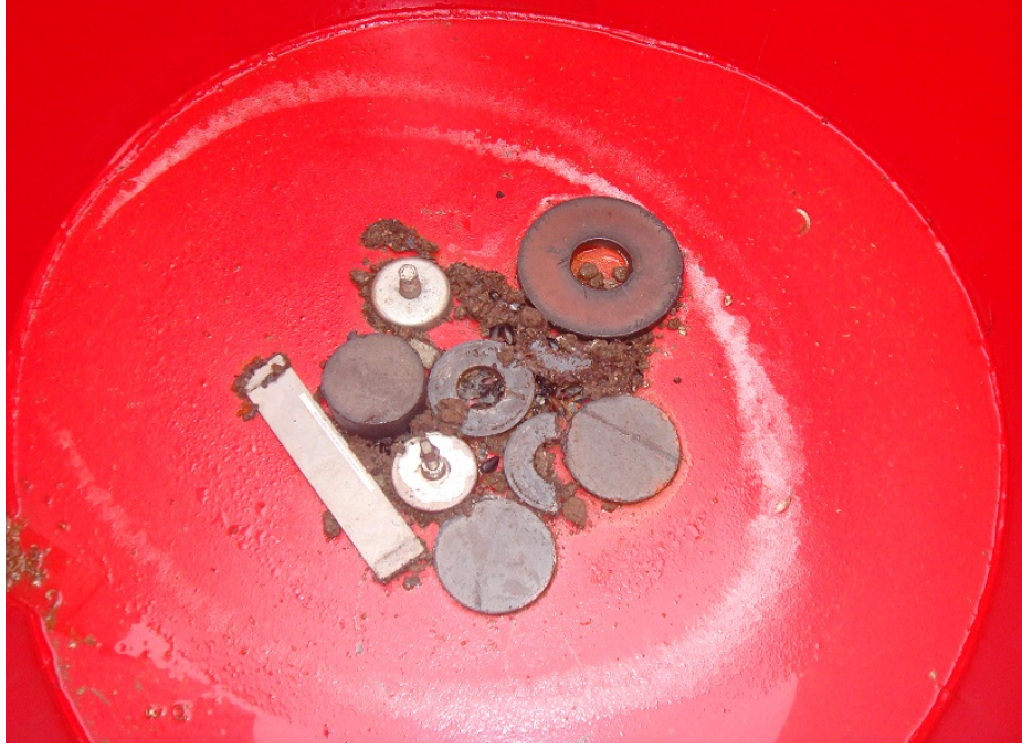
Resim 18. Vorteks Bölümünde Toplanan Katı Madde ve Mıknatıslar
