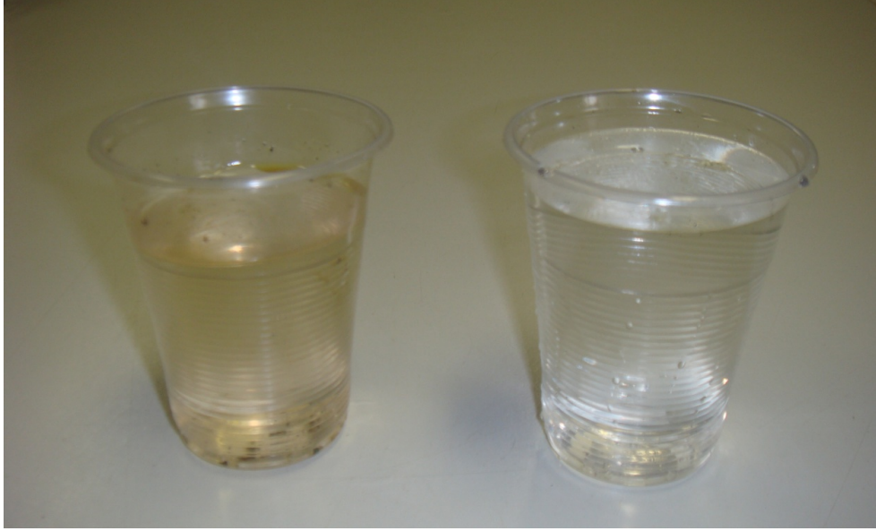
Resim 19. Tank giriş (Solda) ve çıkış numuneleri-01
