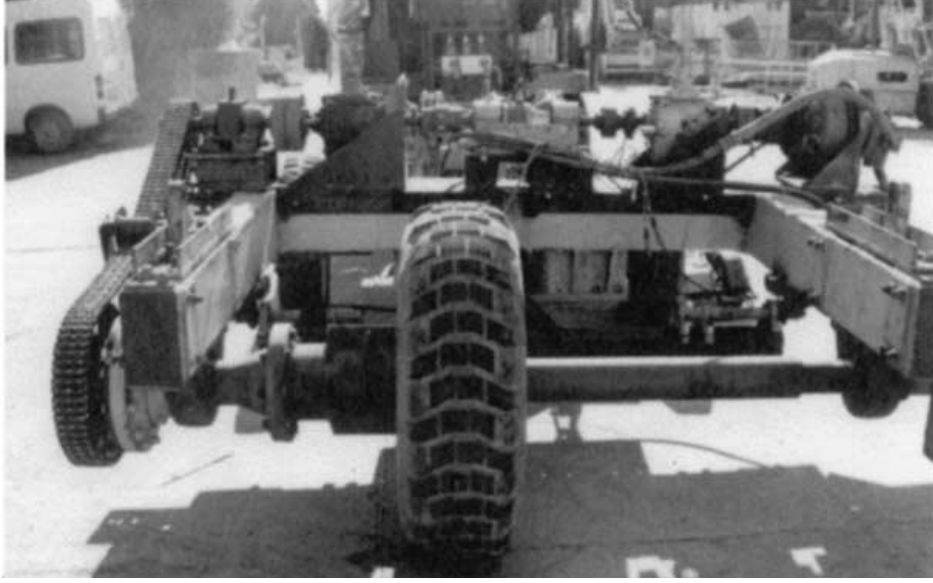
Şekil 2.7. Farklı zeminlerde kullanılabilen deney düzeneği (Shmulevicha ve Osetinskya, 2003)
