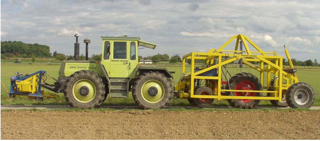
Şekil 2.8. Farklı zeminlerde kullanılabilen deney düzeneği (Ferhadbegović ve ark., 2005)
