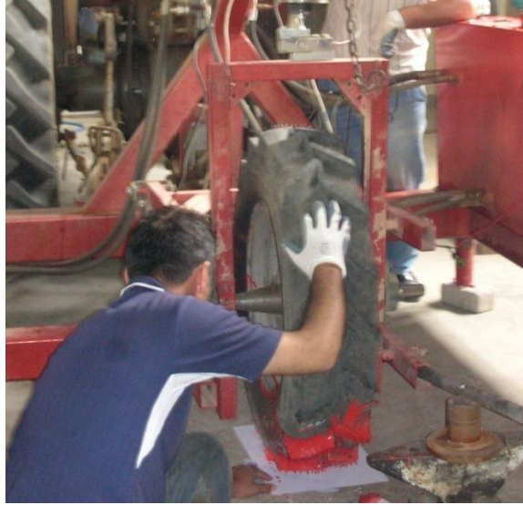
Şekil 3.10. Lastiklerin iz düşüm alanlarının ölçülmesi
