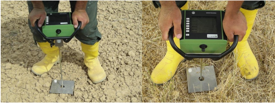
Şekil 3.15. Sürülmüş ve anız tarlada penetrometre ile batma direnci ölçümlerinin yapılması
