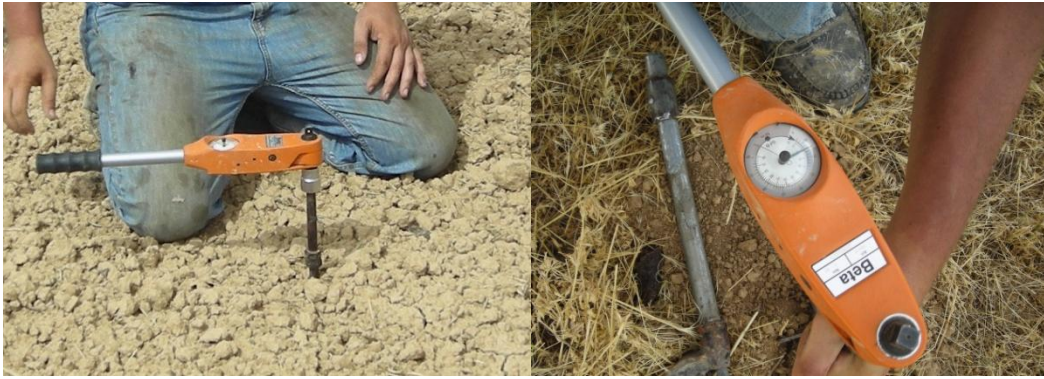
Şekil 3.16. Sürülmüş ve anız tarlada kanatlı kesme aparatı ile kesilme direnci ölçümlerinin yapılışı
