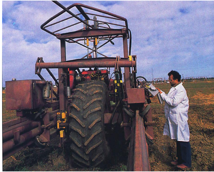
Şekil 2.5. Farklı zeminlerde kullanılabilen deney düzeneği (Upadhyaya ve Wulfsohn, 1989)
