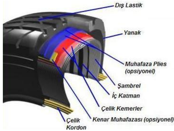
Şekil 1.2. Lastiğin yapısı (Nice, 2010)
