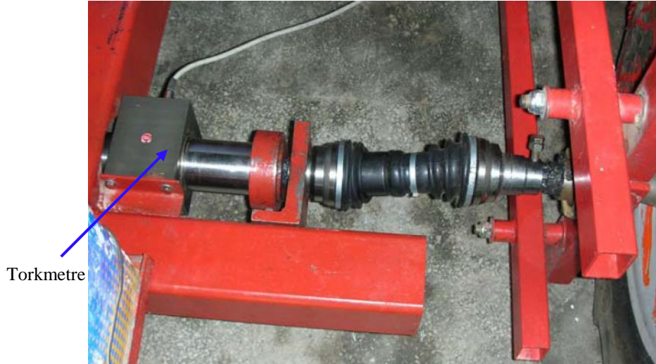
Şekil 3.4. Tork ölçümlerinde kullanılan torkmetre
