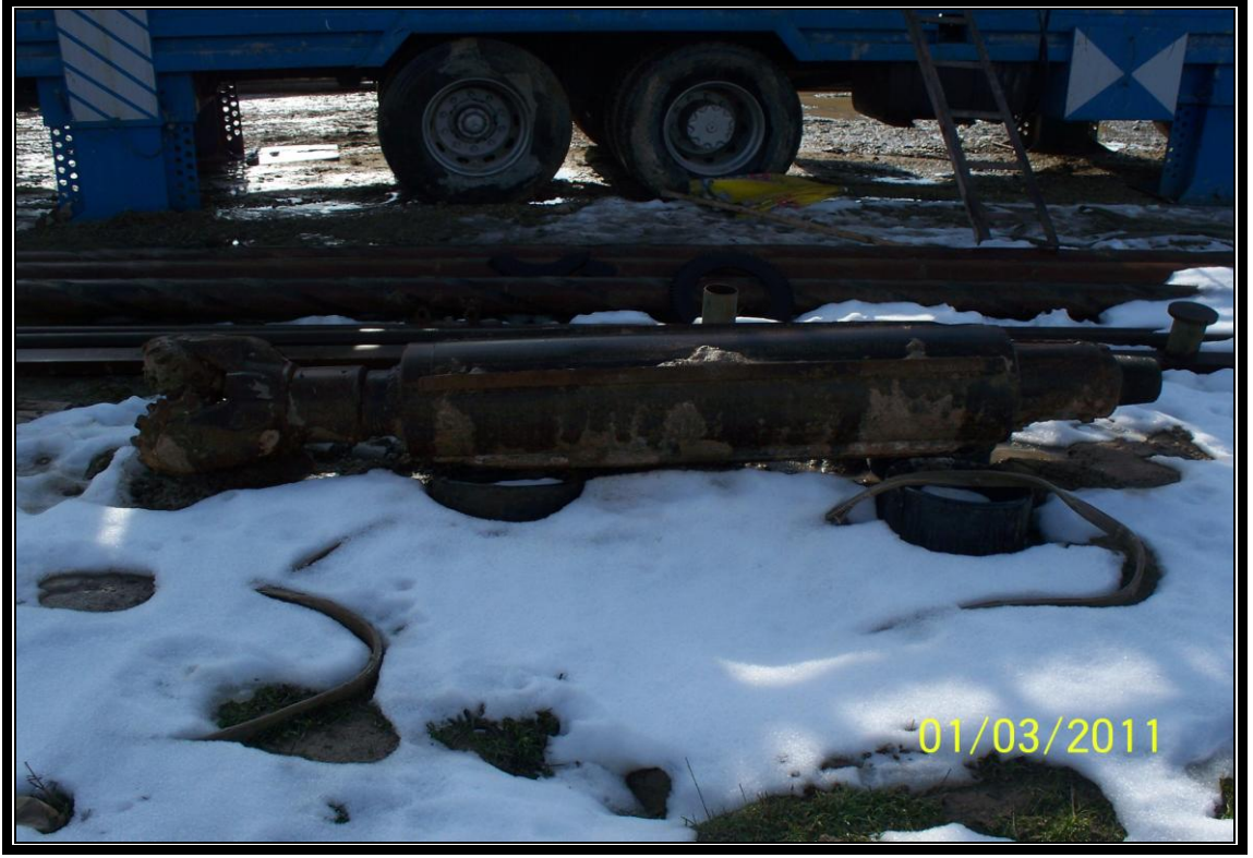
Fotoğraf 2.7 Matkabın üzerine bağlanan ağırlık borusu
