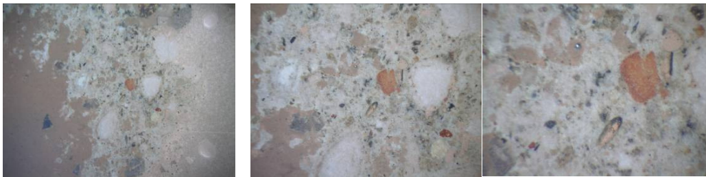
Şekil 5.14 : KU H2 numaralı harcın (0,7/ 1,5 ve 3 oküler) ince kesit fotoğrafları.
