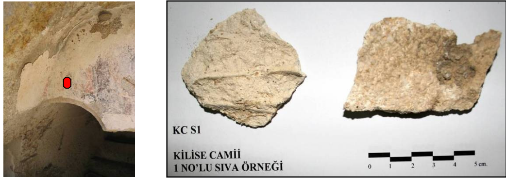
Şekil 4.84 : KC S1 numaralı sıva harcı örneği.
