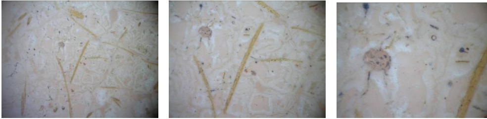
Şekil 5.24 : YK S1 numaralı sıvanın (0,7/ 1,5 ve 3 oküler) ince kesit fotoğrafları.
