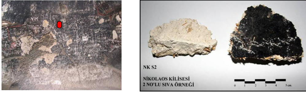
Şekil 4.80 : NK S2 numaralı sıva harcı örneği.
