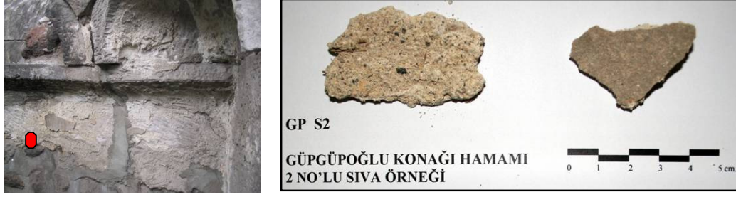
Şekil 4.96 : GP S2 numaralı sıva harcı örneği.
