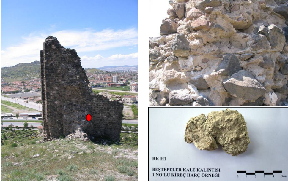
Şekil 4.22 : BK H1 numaralı duvar örgü harcı örneği.
