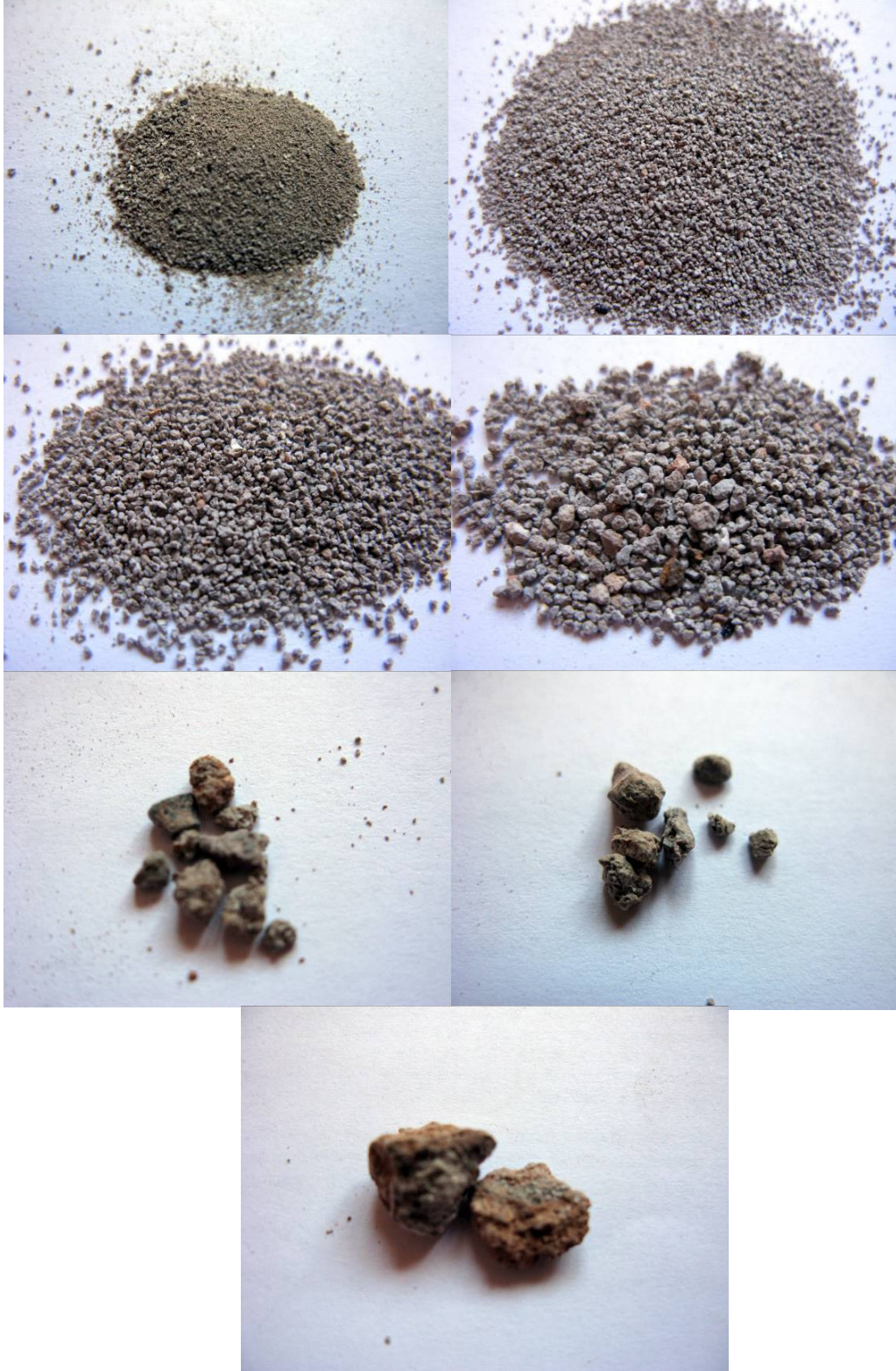
Şekil D.7 : GH H2 numaralı d. harcının asit kaybı analizinden sonra kalan agregaları (125 µ, 250 µ, 500 µ, 1 mm., 2 mm.4 mm., 8 mm. elek üstü).
