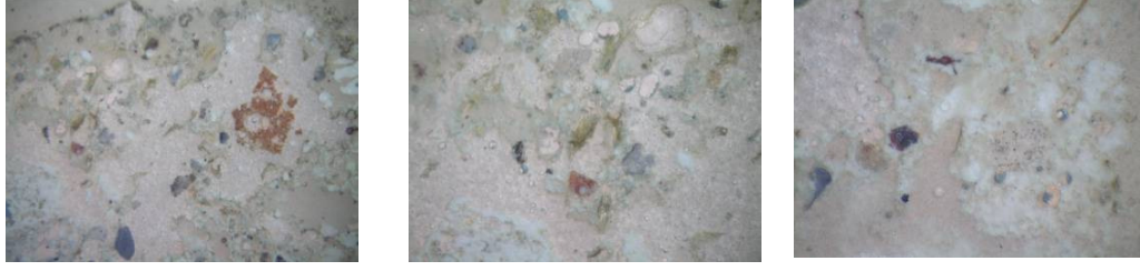
Şekil 5.20 : GP S1 numaralı sıvanın (0,7/ 1,5 ve 3 oküler) ince kesit fotoğrafları.
