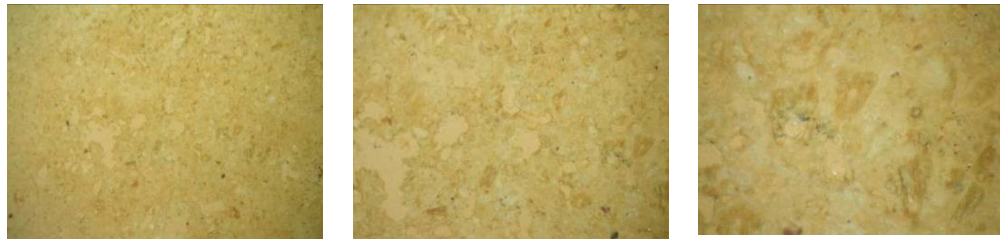
Şekil 5.17 : KK S1 numaralı sıvanın (0,7/ 1,5 ve 3 oküler) ince kesit fotoğrafları.
