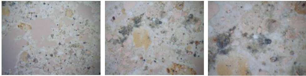
Şekil 5.16 : NK S3 numaralı sıvanın (0,7/ 1,5 ve 3 oküler) ince kesit fotoğrafları.
