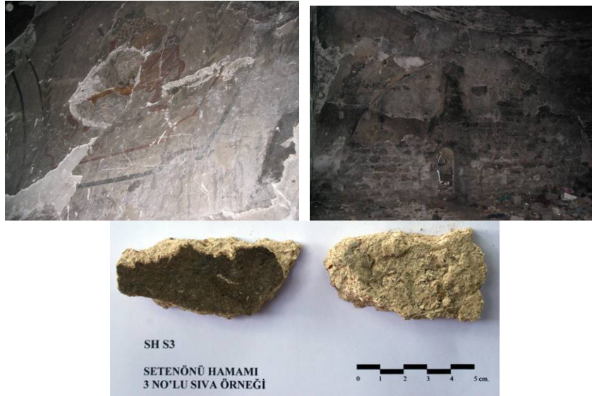
Şekil 4.104 : SH S3 numaralı sıva harcı örneği.
