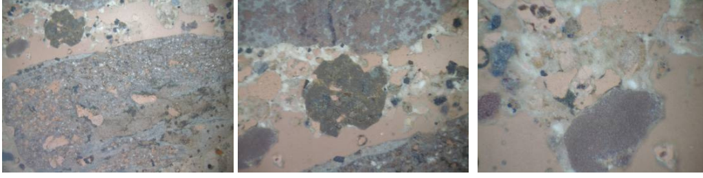
Şekil 5.3 : KP H5 numaralı harcın (0,7/ 1,5 ve 3 oküler) ince kesit fotoğrafları.
