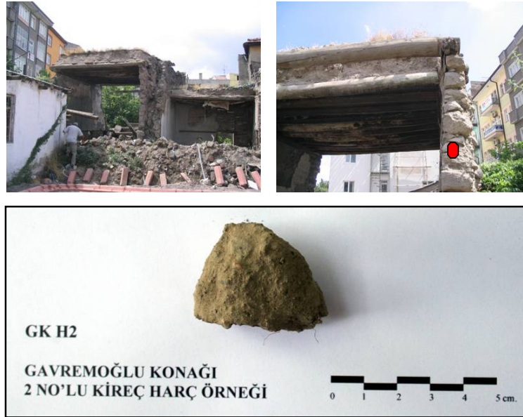
Şekil 4.64 : GK H2 numaralı duvar örgü harcı örneği.
