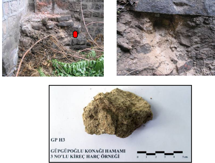
Şekil 4.56 : GP H3 numaralı duvar örgü harcı örneği.
