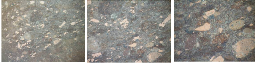
Şekil 6.3 : Develi taşının (0,7/ 1,5 ve 3 oküler) ince kesit fotoğrafları.
