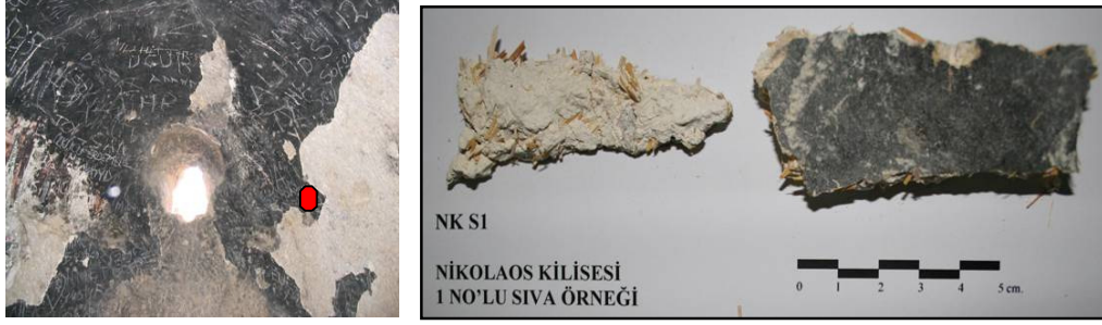
Şekil 4.79 : NK S1 numaralı sıva harcı örneği.
