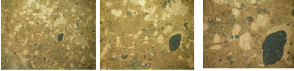
Şekil 6.8 : Şıhbarak taşının (0,7/ 1,5 ve 3 oküler) ince kesit fotoğrafları.
