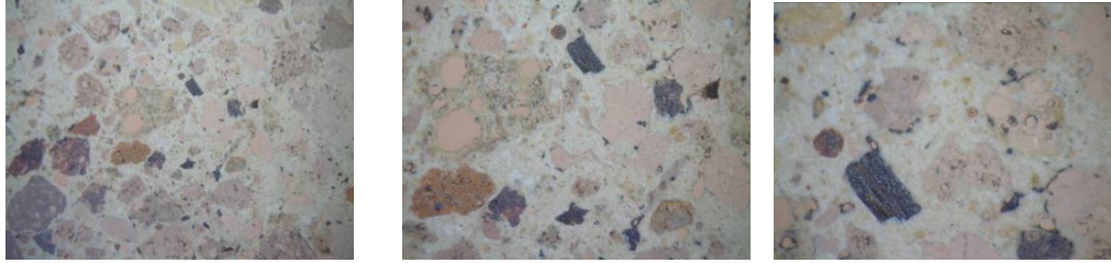
Şekil 5.15 : GK S4 numaralı sıvanın (0,7/ 1,5 ve 3 oküler) ince kesit fotoğrafları.
