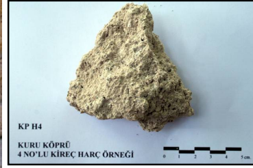
Şekil 4.30 : KP H4 numaralı duvar örgü harcı örneği.
