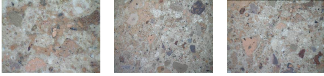
Şekil 5.10 : GP H3 numaralı harcın (0,7/ 1,5 ve 3 oküler) ince kesit fotoğrafları.
