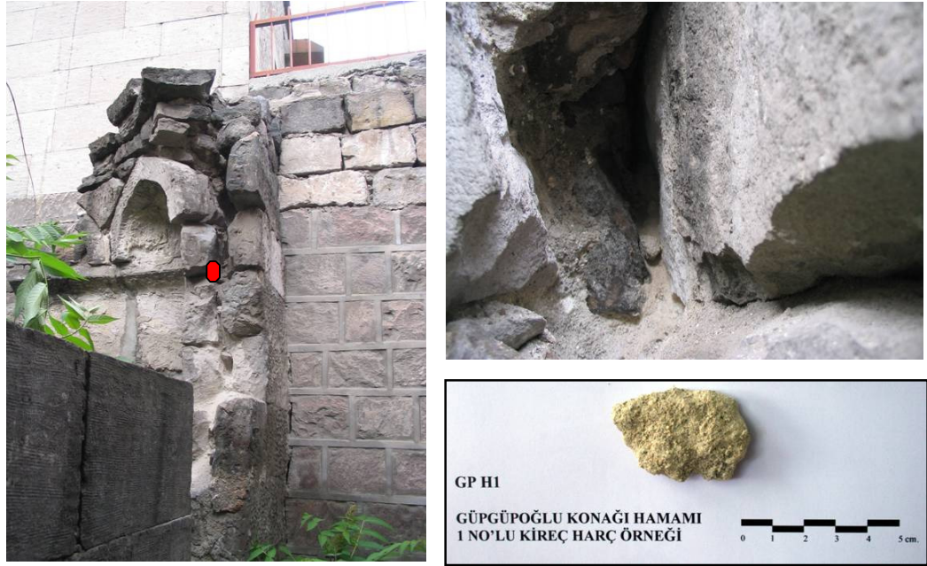
Şekil 4.54 : GP H1 numaralı duvar örgü harcı örneği.
