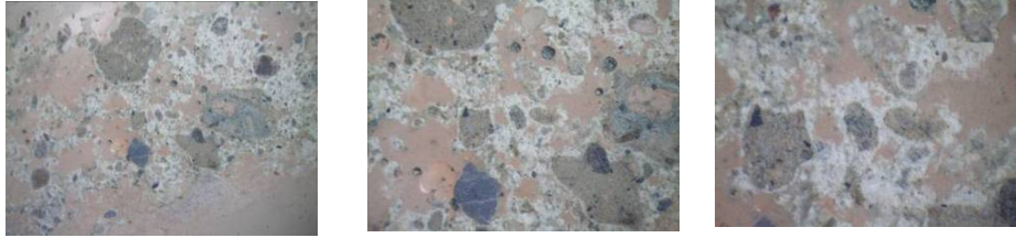
Şekil 5.11 : GH H1 numaralı harcın (0,7/ 1,5 ve 3 oküler) ince kesit fotoğrafları.
