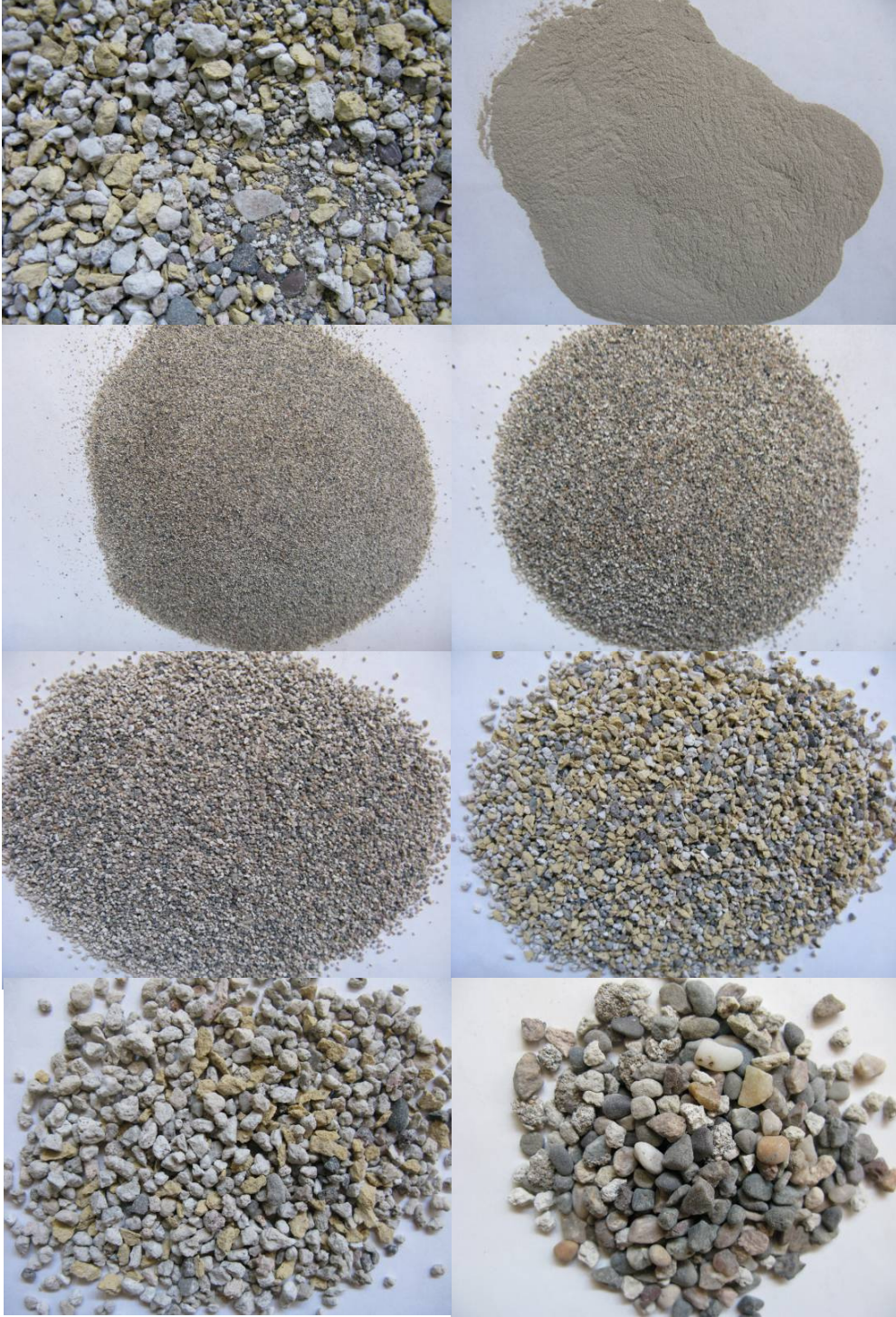
Şekil E.7 : Sıva 1 onarım harcında kullanılan agregalar (Agrega karışımı, <63 \mu puzolan, 125 \mu , 250 \mu , 500 \mu , 1 \text{ mm.} , 2 \text{ mm.} , 4 \text{ mm.} elek üstü).
