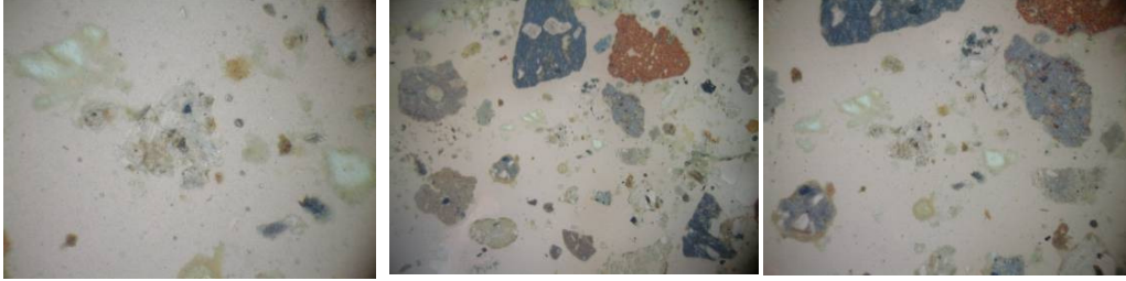
Şekil 5.18 : KK S2 numaralı sıvanın (0,7/ 1,5 ve 3 oküler) ince kesit fotoğrafları.
