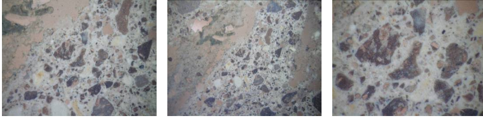
Şekil 5.4 : AB H1 numaralı harcın (0,7/ 1,5 ve 3 oküler) ince kesit fotoğrafları.
