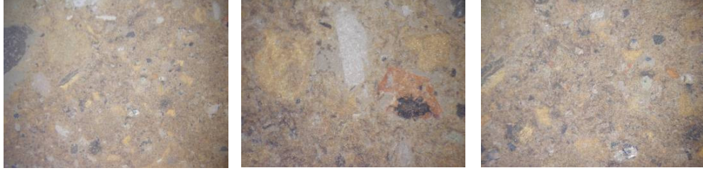
Şekil 6.2 : Başakpınar taşının (0,7/ 1,5 ve 3 oküler) ince kesit fotoğrafları.
