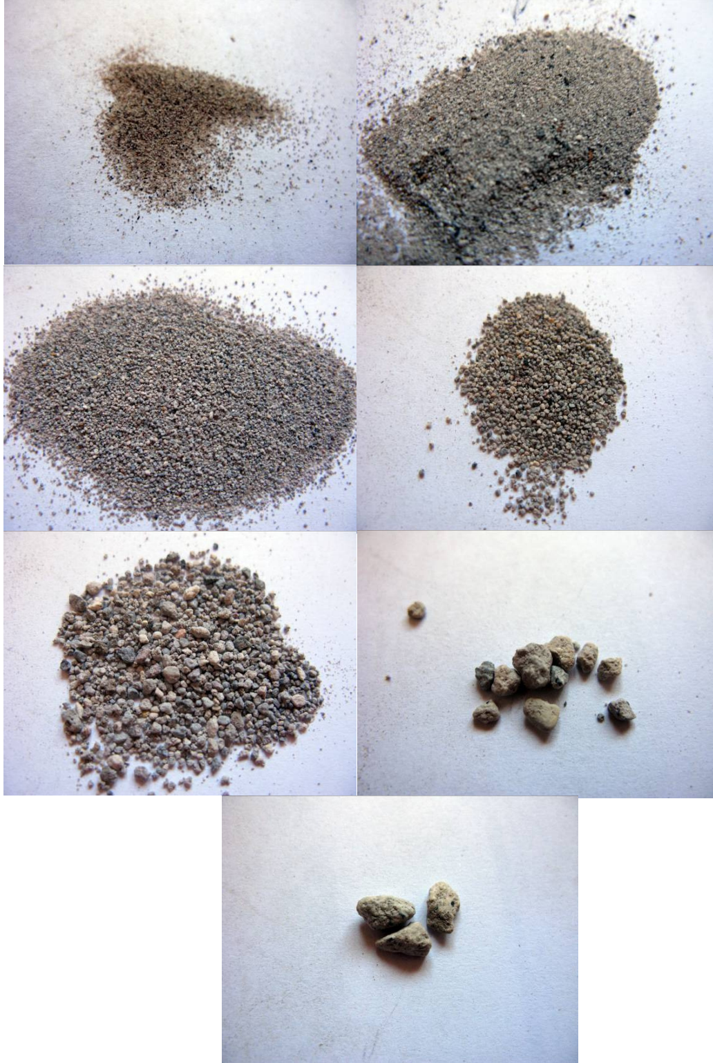
Şekil D.6 : GP H2 numaralı d. harcının asit kaybı analizinden sonra kalan agregaları (63 µ, 125 µ, 250 µ, 500 µ, 1 mm., 2 mm. elek üstü).
