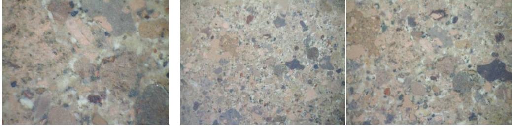
Şekil 5.6 : KK H1 numaralı harcın (0,7/ 1,5 ve 3 oküler) ince kesit fotoğrafları.
