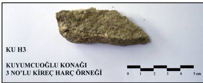
Şekil 4.69 : KU H3 numaralı duvar örgü harcı örneği.
