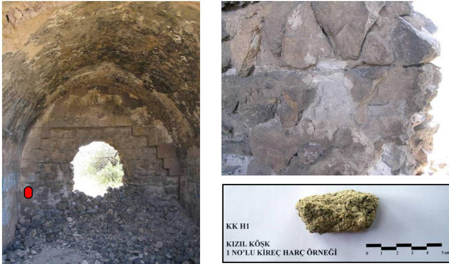
Şekil 4.46 : KK H1 numaralı duvar örgü harcı örneği.
