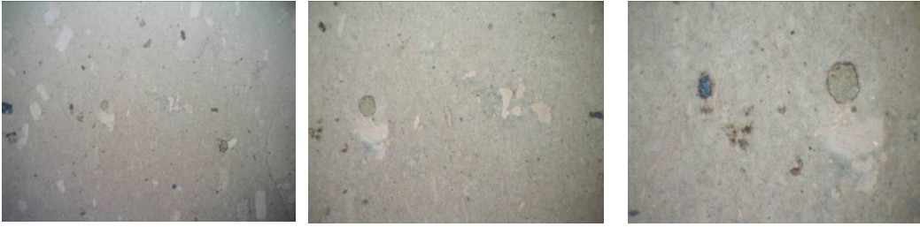
Şekil 6.5 : Kamber taşının (0,7/ 1,5 ve 3 oküler) ince kesit fotoğrafları.
