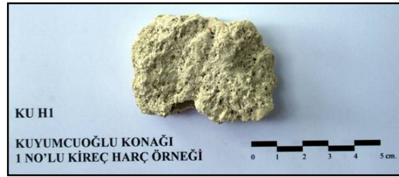
Şekil 4.67 : KU H1 numaralı duvar örgü harcı örneği.
