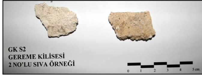
Şekil 4.73 : GK S2 numaralı sıva harcı örneği.
