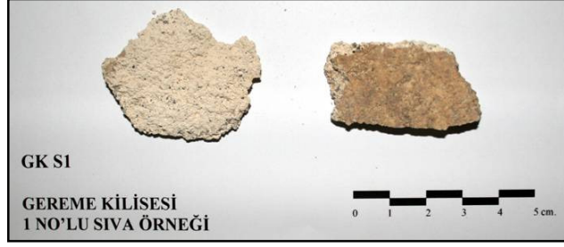
Şekil 4.72 : GK S1 numaralı sıva harcı örneği.
