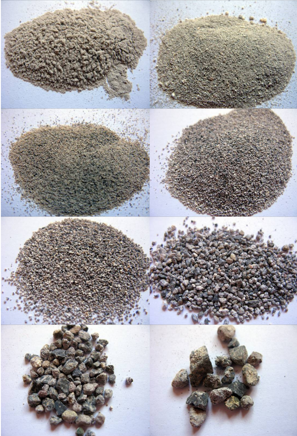
Şekil D.1 : AB H3 numaralı d. harcının asit kaybı analizinden sonra kalan agregaları (<63 µ, 63 µ, 125 µ, 250 µ, 500 µ, 1 mm., 2 mm, 4 mm. elek üstü).
