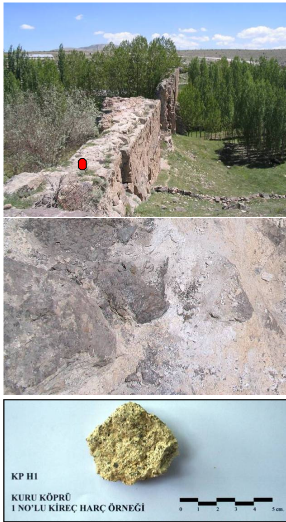
Şekil 4.27 : KP H1 numaralı duv. harcı örneği. Şekil 4.28 : KP H2 numaralı örnek.
