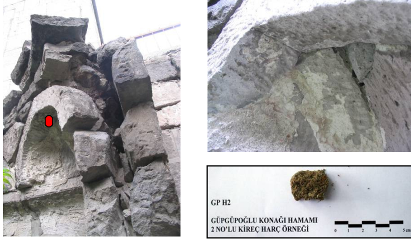
Şekil 4.55 : GP H2 numaralı duvar örgü harcı örneği.
