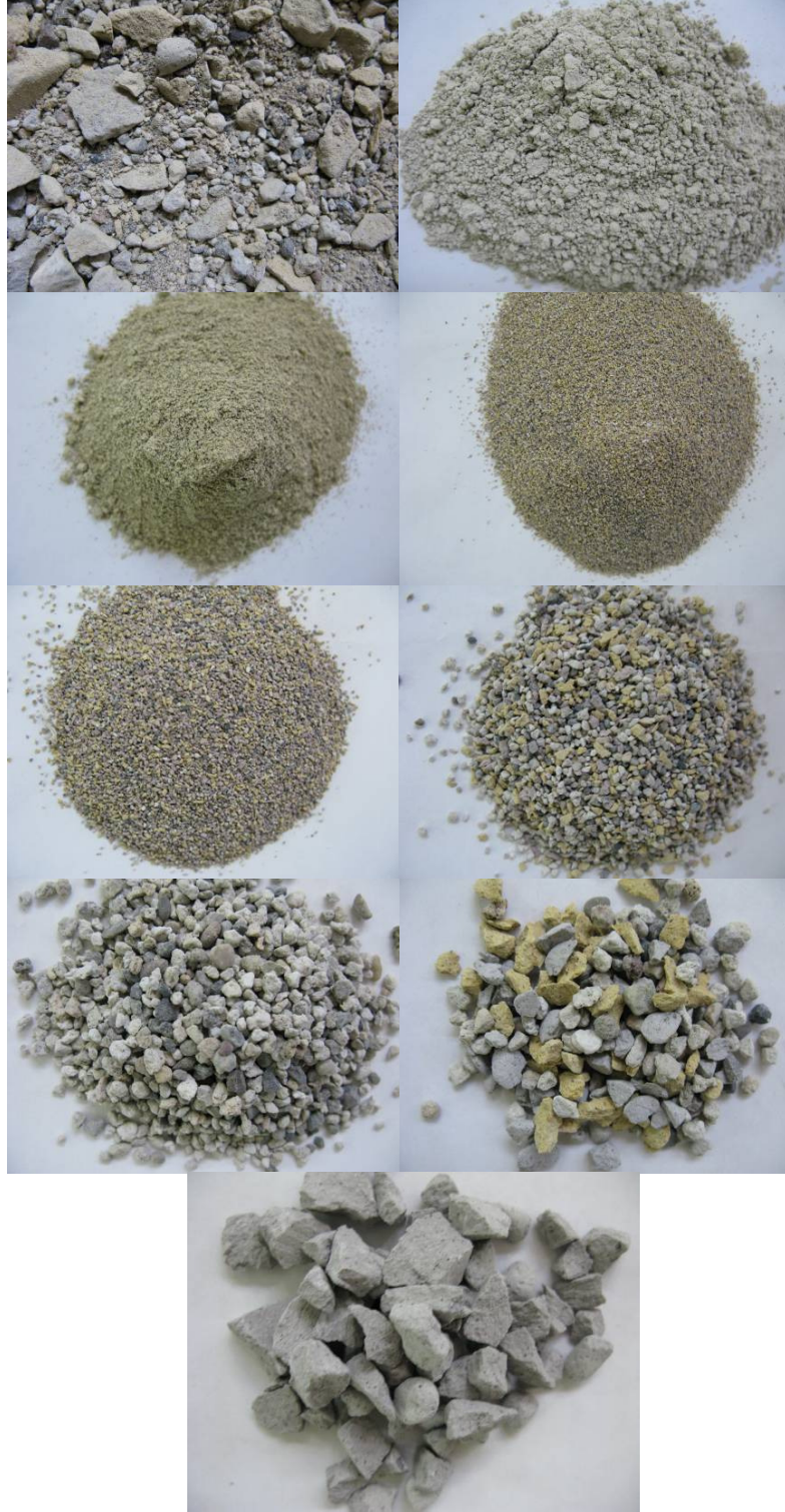
Şekil E.5 : Harç 2 onarım harcında kullanılan agregalar (Agrega karışımı, <math><63 \mu</math> puzolan, 125 \mu , 250 \mu , 500 \mu , 1 mm., 2 mm, 4 mm., 8 mm. elek üstü).
