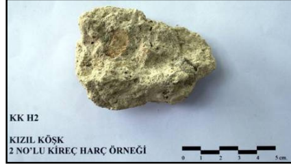
Şekil 4.47 : KK H2 numaralı duvar örgü harcı örneği.
