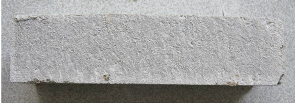
Şekil 6.15 : Sıva 1 onarım harcı önerisi.
