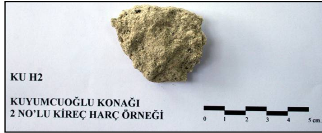
Şekil 4.68 : KU H2 numaralı duvar örgü harcı örneği.
