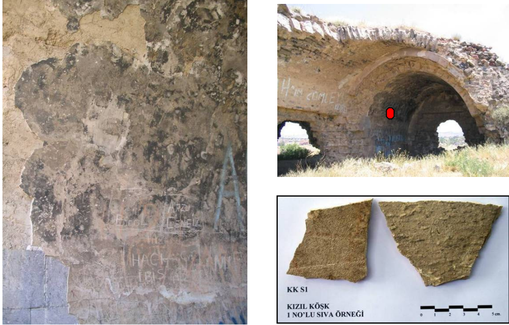
Şekil 4.93 : KK S1 numaralı sıva harcı örneği.
