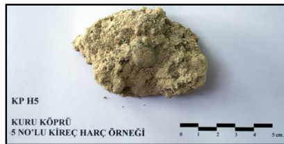
Şekil 4.31 : KP H5 numaralı duvar örgü harcı örneği.
