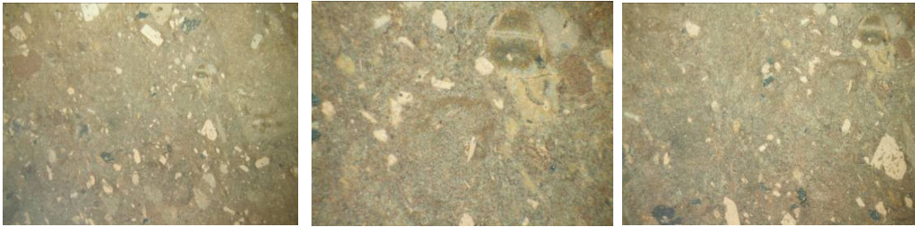
Şekil 6.6 : Tomarza taşının (0,7/ 1,5 ve 3 oküler) ince kesit fotoğrafları.
