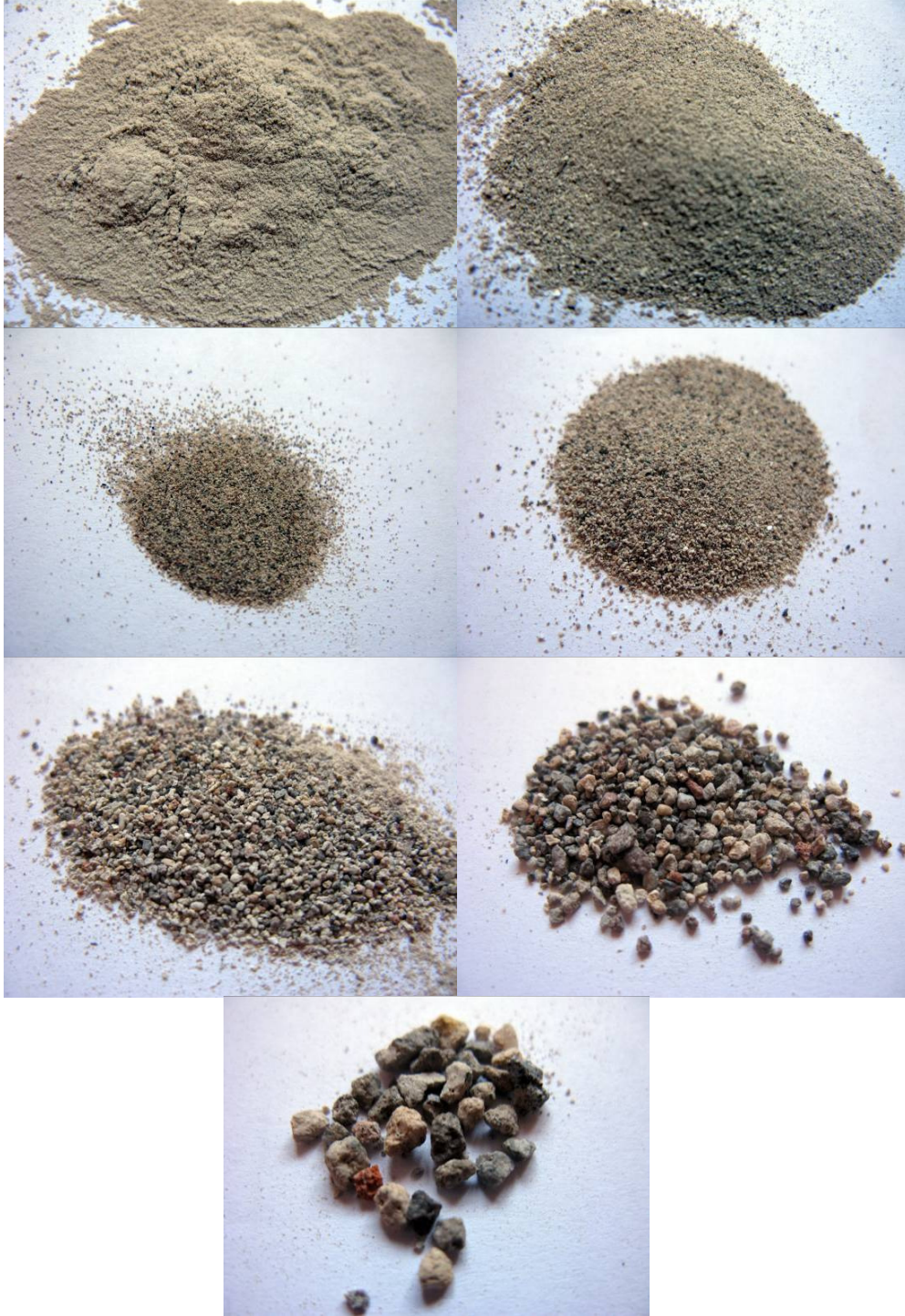
Şekil D.5 : KK H2 numaralı d. harcının asit kaybı analizinden sonra kalan agregaları (<63 µ, 63 µ, 125 µ, 250 µ, 500 µ, 1 mm., 2 mm. elek üstü).
