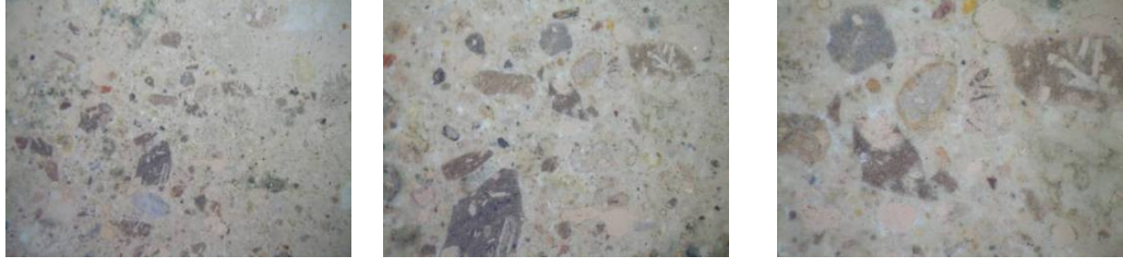
Şekil 5.5 : AB H2 numaralı harcın (0,7/ 1,5 ve 3 oküler) ince kesit fotoğrafları.
