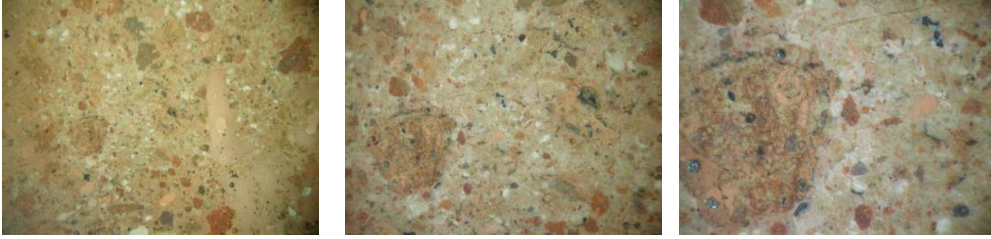
Şekil 5.23 : SH S3 numaralı sıvanın (0,7/ 1,5 ve 3 oküler) ince kesit fotoğrafları.
