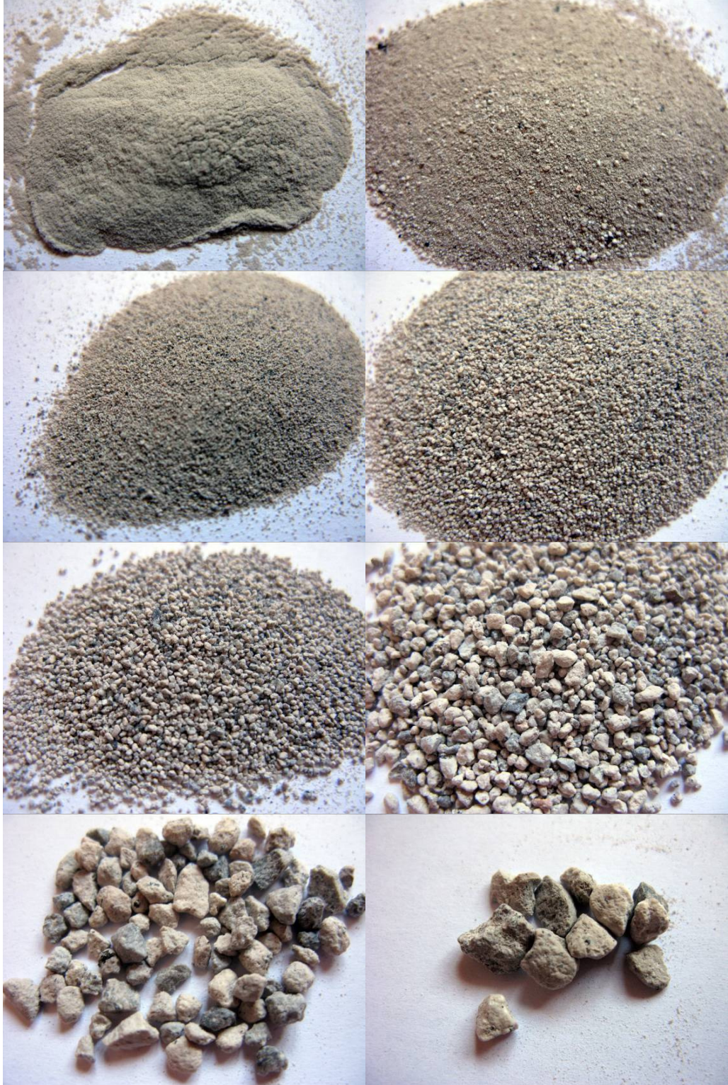
Şekil D.2 : BK H2 numaralı d. harcının asit kaybı analizinden sonra kalan agregaları (<math><63 \mu</math>, <math>63 \mu</math>, <math>125 \mu</math>, <math>250 \mu</math>, <math>500 \mu</math>, <math>1 \text{ mm}</math>, <math>2 \text{ mm}</math>, <math>4 \text{ mm}</math>. elek üstü).
