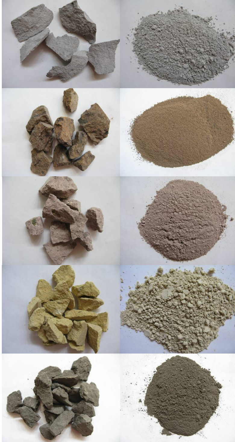
Şekil E.3 : Puzolan olarak kullanılan tüfler ve 63 mikron altı öğütülmüş tozları (Gri Kamber trakitik tüfü, Kahverengi Başakpınar trakitik tüfü, Pembe Erkiyet riylitik tüfü, Sarı Koççağız trakitik tüfü, Siyah Tomarza andezitik tüfü).
