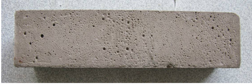
Şekil 6.16 : Sıva 2 onarım harcı önerisi.
