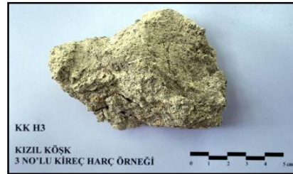
Şekil 4.48 : KK H3 numaralı duvar örgü harcı örneği.
