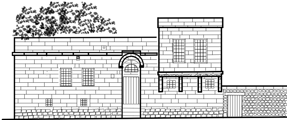
Şekil 4.15 : Geleneksel dokuda kesme taş duvar örgüsünün kullanımı (Çizim: Hale Kozlu).
