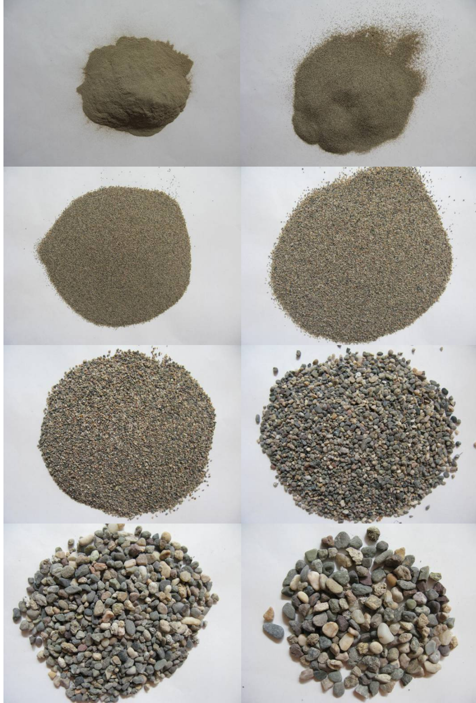
Şekil E.2 : Kızılırmak kumu (<63 µ, 63 µ, 125 µ, 250 µ, 500 µ, 1 mm., 2 mm, 4 mm.. elek üstü).
