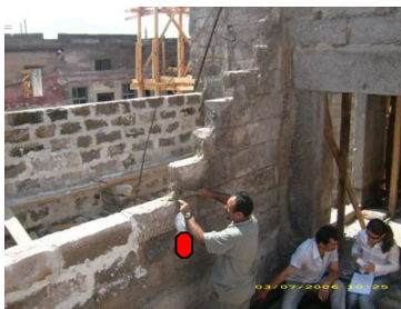
Şekil 4.69 : KU H3 numaralı duvar örgü harcı örneği.
