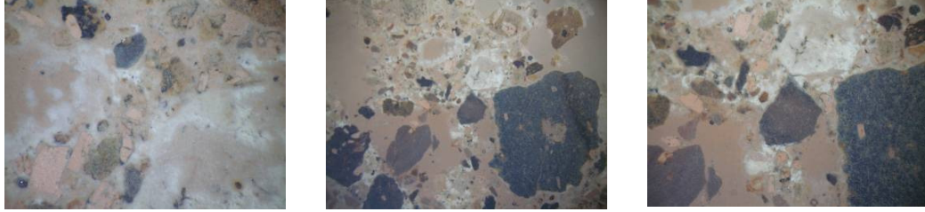
Şekil 5.1 : KP H2 numaralı harcın (0,7/ 1,5 ve 3 oküler) ince kesit fotoğrafları.
