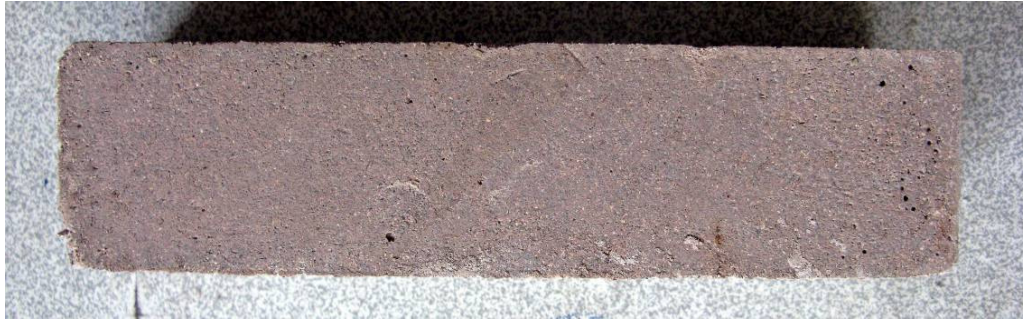
Şekil 6.14 : Harç 3 onarım harcı önerisi.
