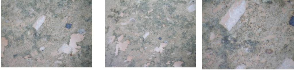
Şekil 5.8 : GM H3 numaralı harcın (0,7/ 1,5 ve 3 oküler) ince kesit fotoğrafları.
