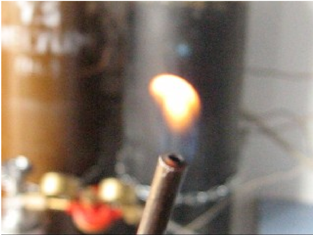
Şekil 7.13 Elde edilen gaz ürünün yanması (7.5 mL/dk besleme debisi, 650°C, 250 bar)
