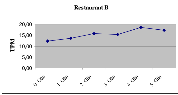
Şekil 4.23 Restaurant B’de gerçekleştirilen kızartma işleminde toplam polar maddenin kızartma sayısına bağlı değişimi
