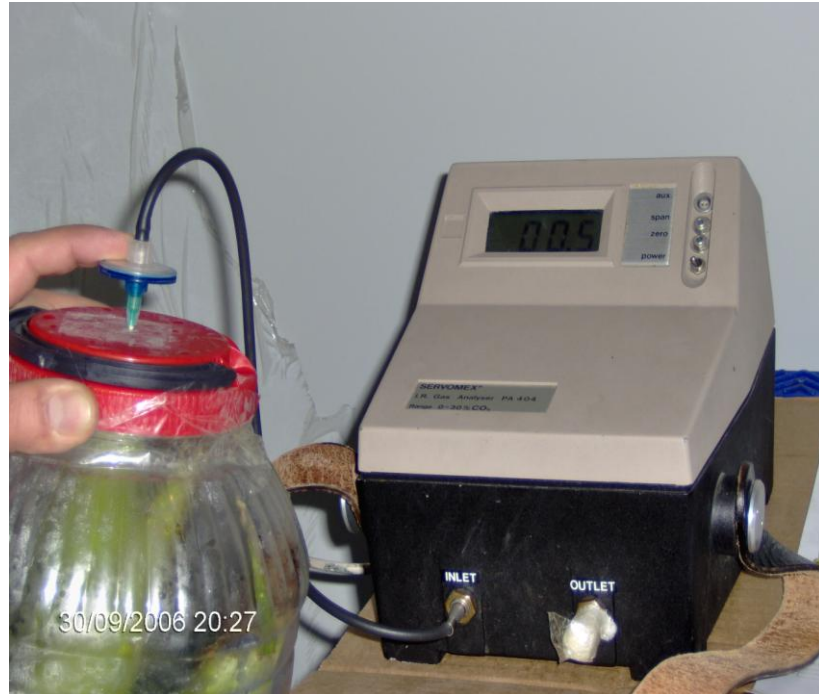
Şekil 3.13 5 litrelik kavanozlara yerleştirilen mısırların infrared CO 2 analizatörü ile kapalı atmosfer yöntemine göre CO 2 değerinin ölçülmesi
