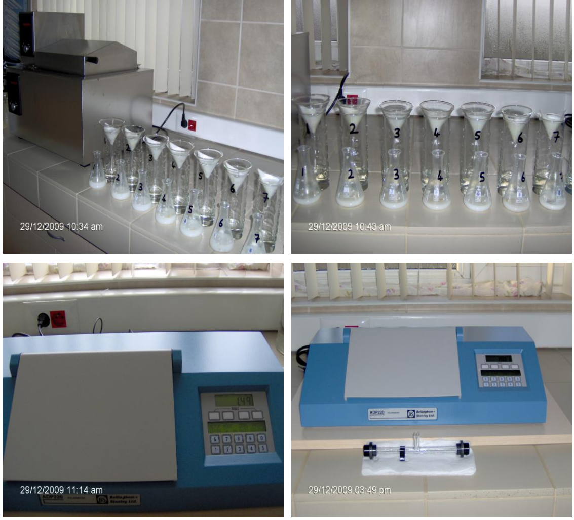
Şekil 3.15 Nişasta analizinde örneklerin süzülmesi ve değerlerin polarimetrede ölçülmesi
