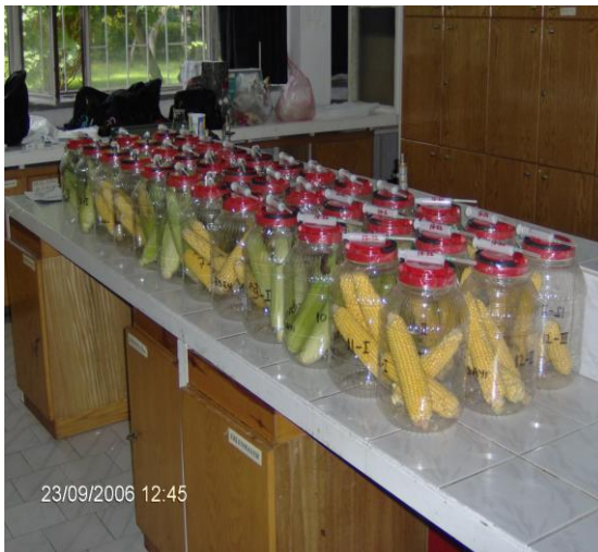
Şekil 3.12 0 °C ve 18 °C sıcaklıkta, 5 litrelik kavanozlara yerleştirilen mısırlarda, etilen üretiminin belirlenmesinde kullanılacak olan gazın enjektörlere çekilmesi
