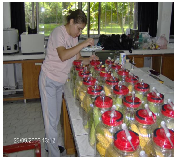
Şekil 3.12 0 °C ve 18 °C sıcaklıkta, 5 litrelik kavanozlara yerleştirilen mısırlarda, etilen üretiminin belirlenmesinde kullanılacak olan gazın enjektörlere çekilmesi
