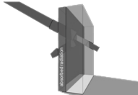
Şekil 2.1. : Yansıma yoluyla dağıtma Şekil 2.2. : Geçirgenlik yoluyla dağıtma
