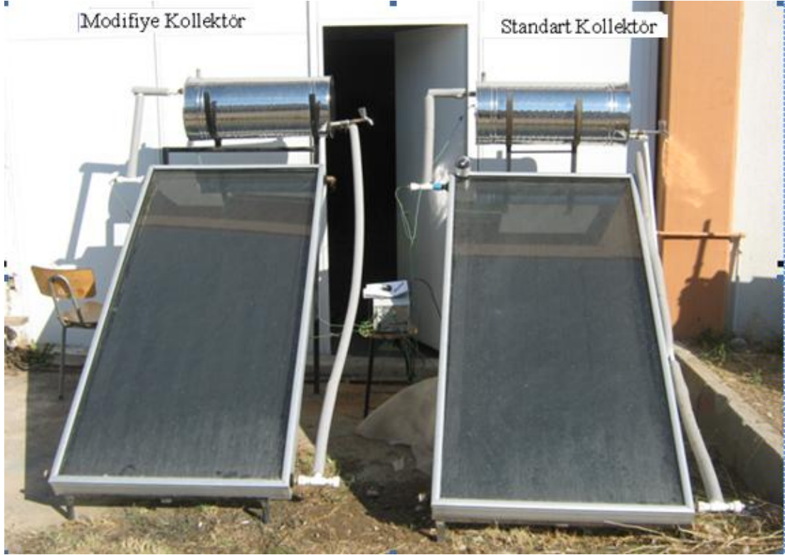
Şekil 3. 14. Standart ve modifiye güneş kollektörü
