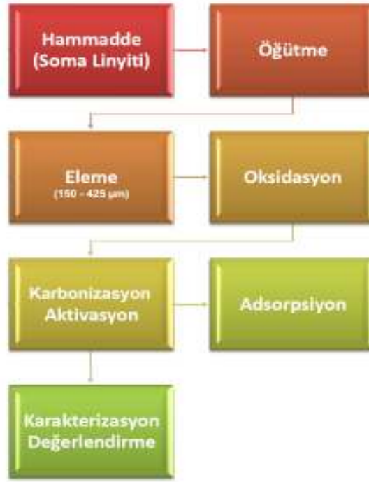
Şekil 7.3 Gerçekleştirilen çalışmanın basit akış diyagramı
