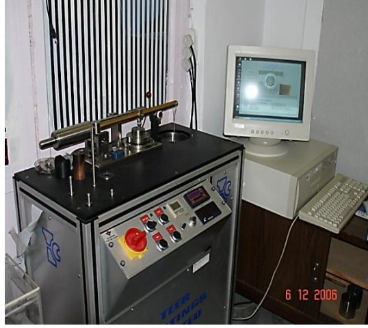
Şekil 3.7. Teer-POD-2 pin-on-disk aşınma cihazı
