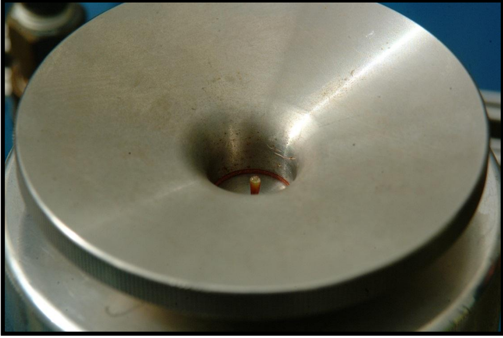
Şekil 3.51 Basınç pompasına yerleştirilmiş yaprak sapı
