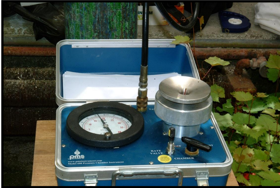
Şekil 3.48 Yaprak su potansiyelinin ölçümünde kullanılan basınç pompası
