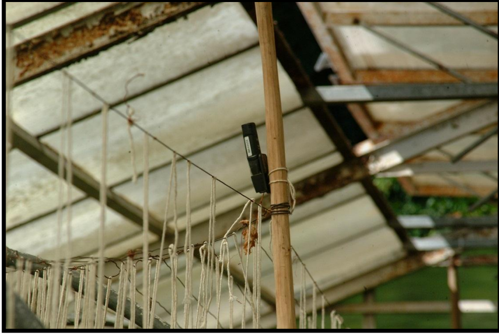
Şekil 3.54 Denemede kullanılan bitkilerin bulunduđu ortamın nem ve sıcaklığının data logger ile ölçülmesi
