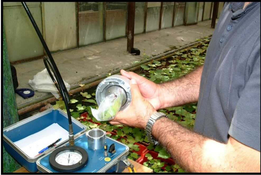
Şekil 3.50 Yaprak su potansiyelinin basınç pompası ile ölçülmesi
