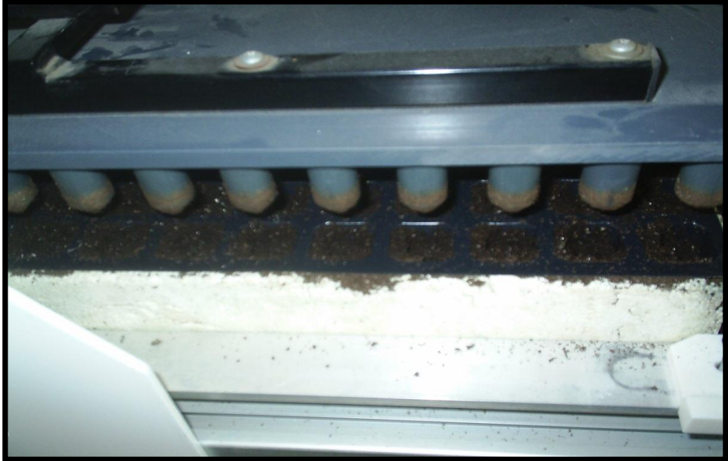
Şekil 3.27 F1 hibrit tohumlarının ekim derinliğinin otomatik olarak makina ile ayarlanması
