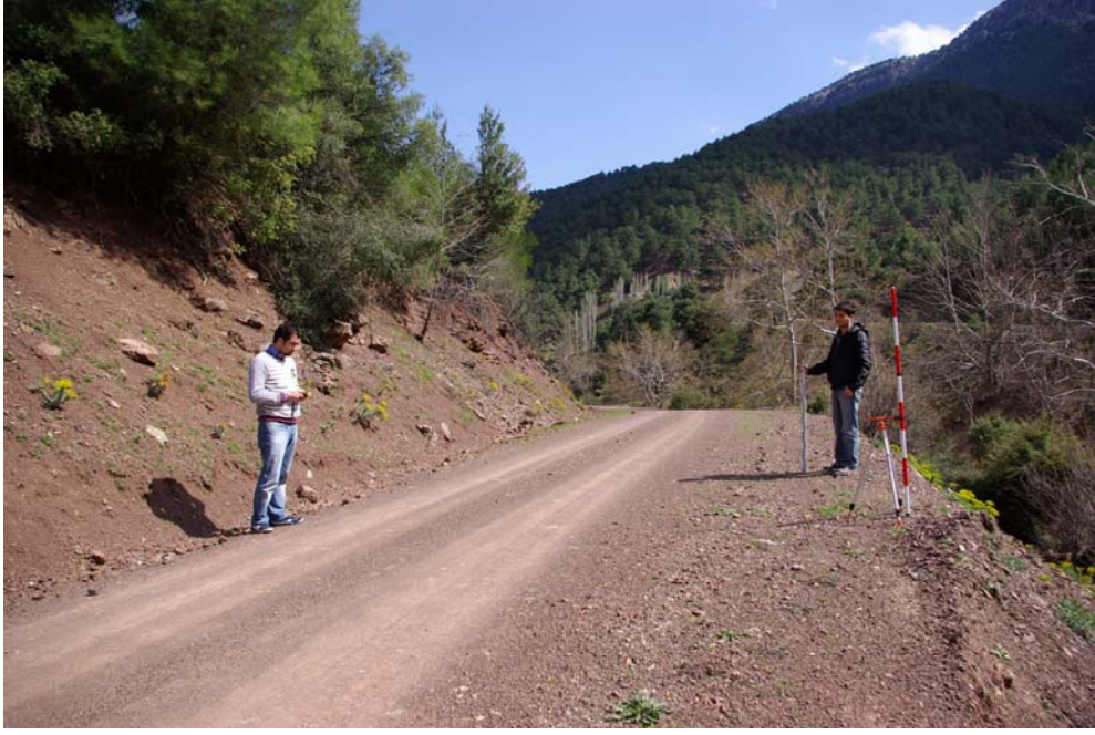
Şekil 3.14. Durma noktalarında yol genişliklerinin dijital mesafe ölçer ile ölçülmesi
