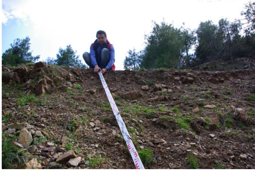
Őekil 3.19. Durma noktalarında dolgu Őevi uzunluęunun ölçölmesi
