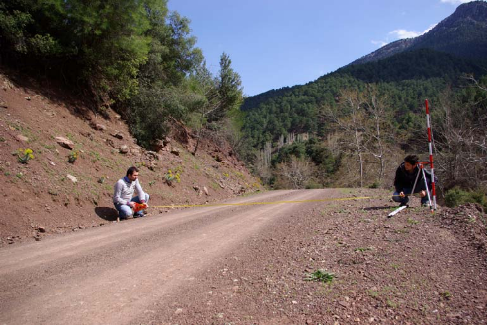
Şekil 3.15. Durma noktalarında yol genişliklerinin şeritmetre ile ölçülmesi
