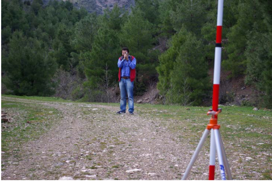
Şekil 3.16. Durma noktalarında yol eğiminin ölçülmesi
