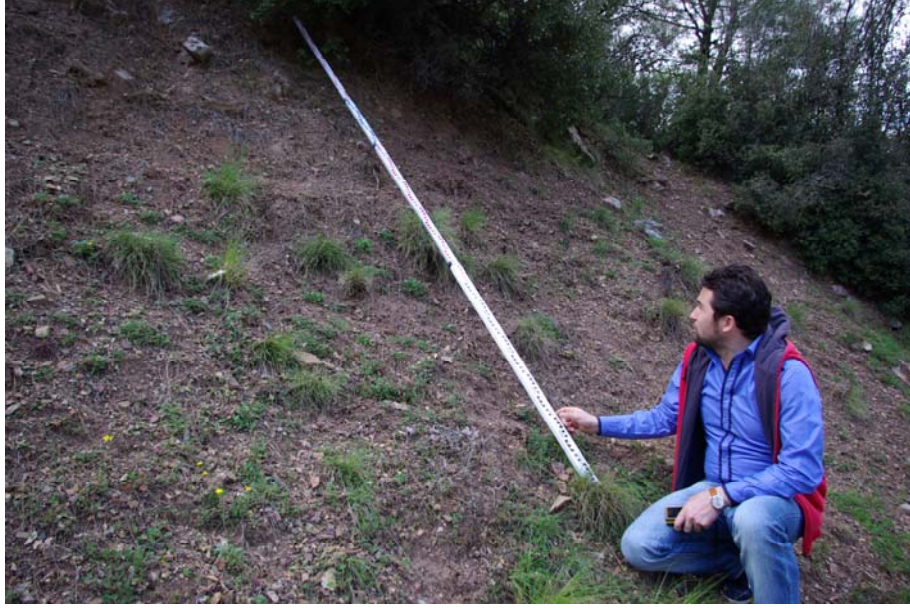
Şekil 3.17. Durma noktalarında kazı şevi uzunluğunun ölçülmesi
