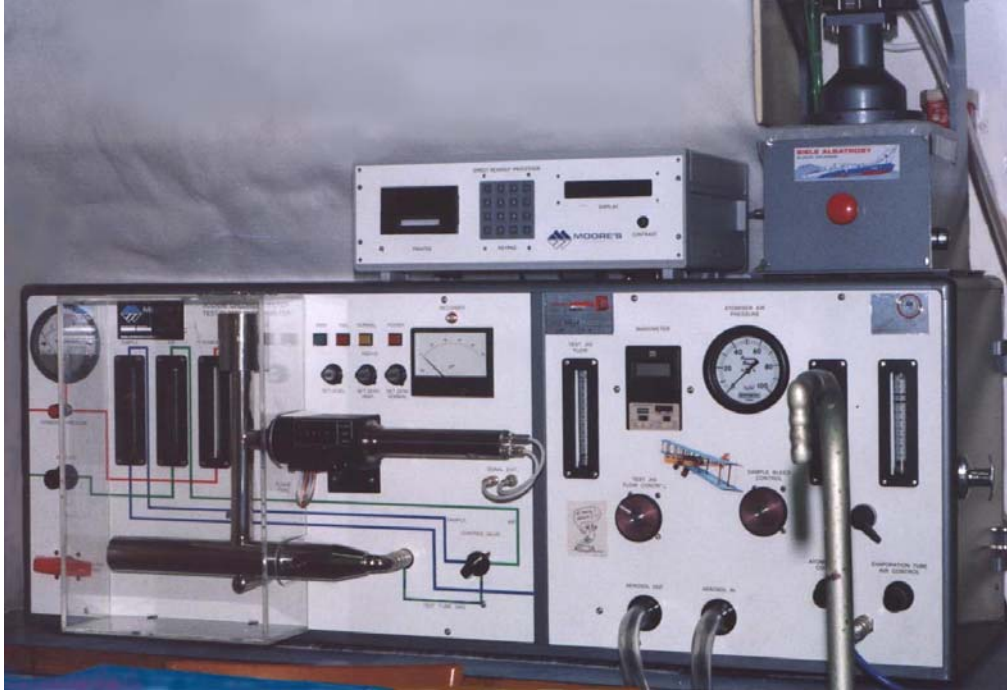
Şekil 6.3 NaCl Aerosol Test Düzenegi(Librec Teknik Üniversitesi-Filtre Laboratuarı).
