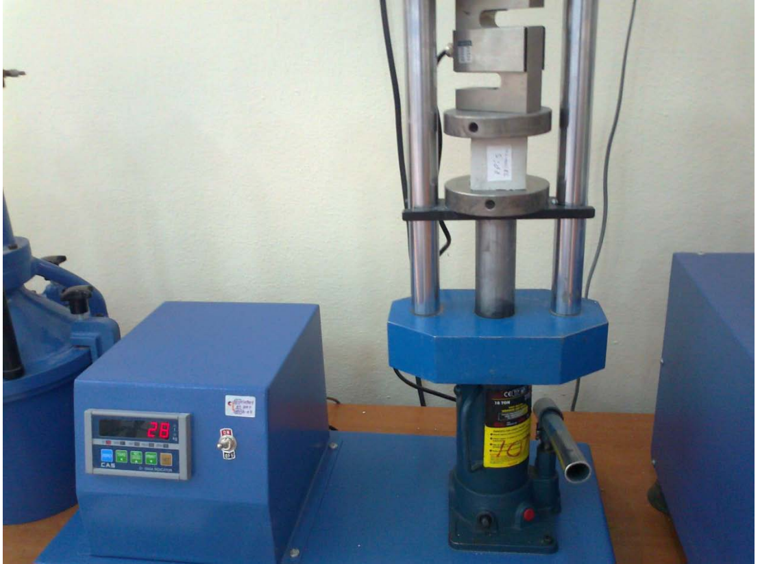
Şekil 4.5. Basınç dayanımı analizi
