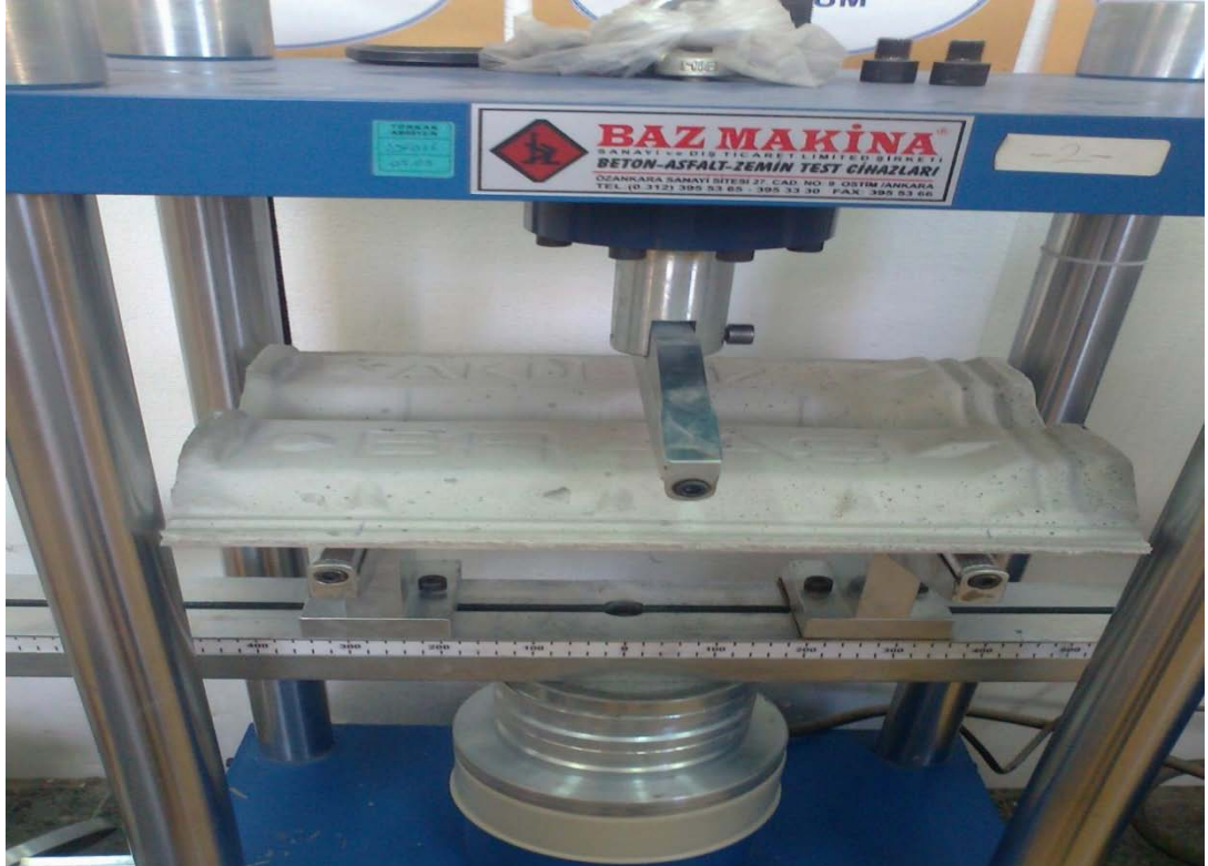
Şekil 4.23. Hafif beton kiremidin eğileme dayanımı analizi
