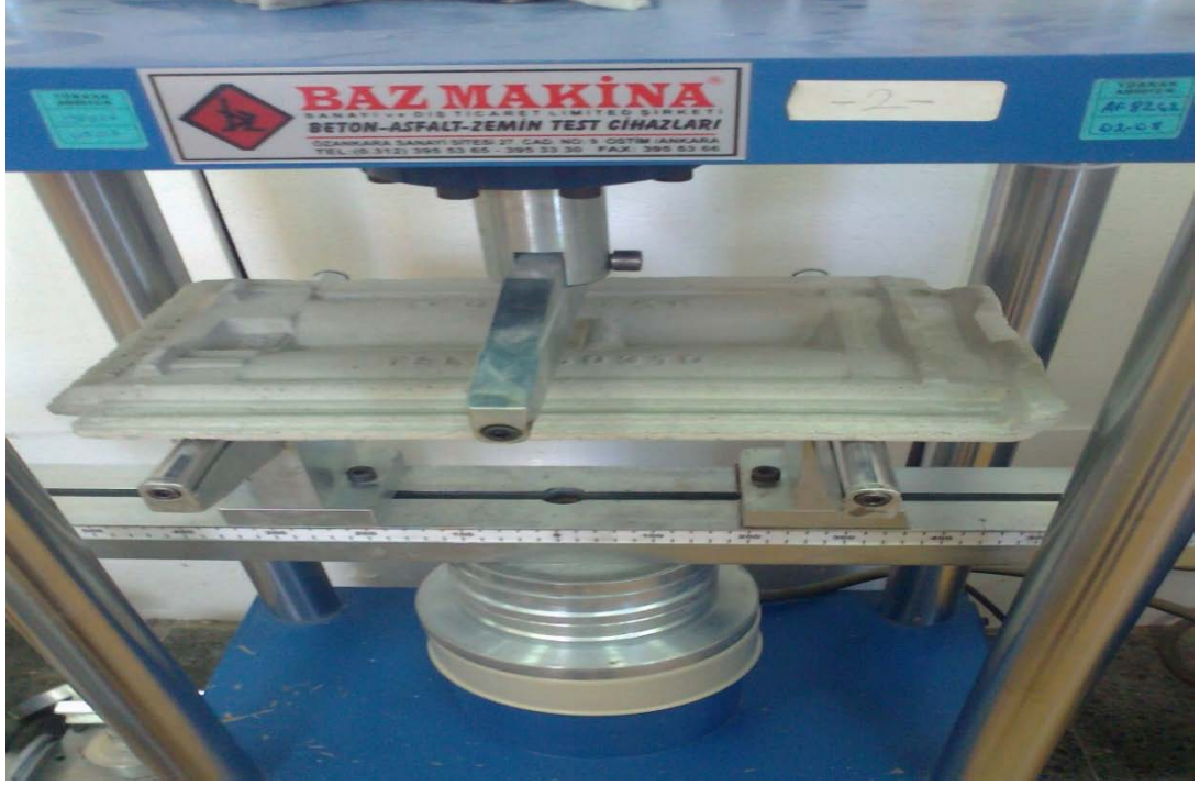
Şekil 4.22. Marsilya tipi hafif kiremidin eğileme dayanımı analizi
