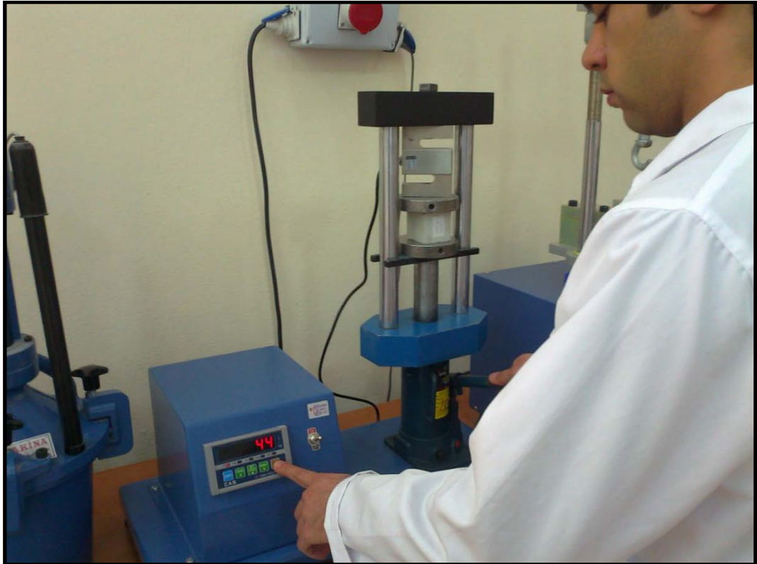
Şekil 4.2. Tek eksenli basınç dayanımı analizi
