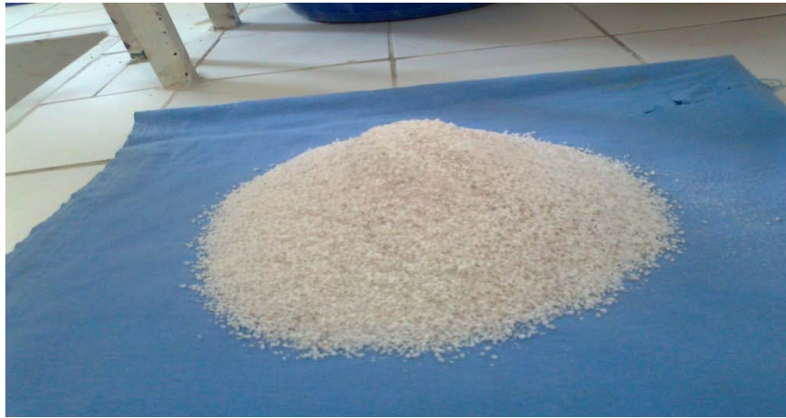
Şekil 3.5. Genleştirilmiş perlit agregasının görünümü
