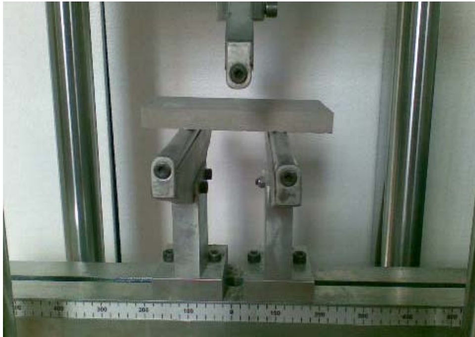
Şekil 4.12. Eğilme dayanımı testinden örnek bir görünüm
