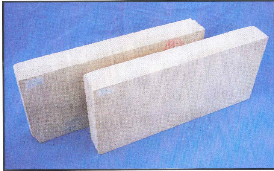
Şekil 4.59. Mahfazalı sıcak kutu yöntemine göre ısı iletkenlik ölçümü yapılmış deney numunelerinden bir görünüm.
