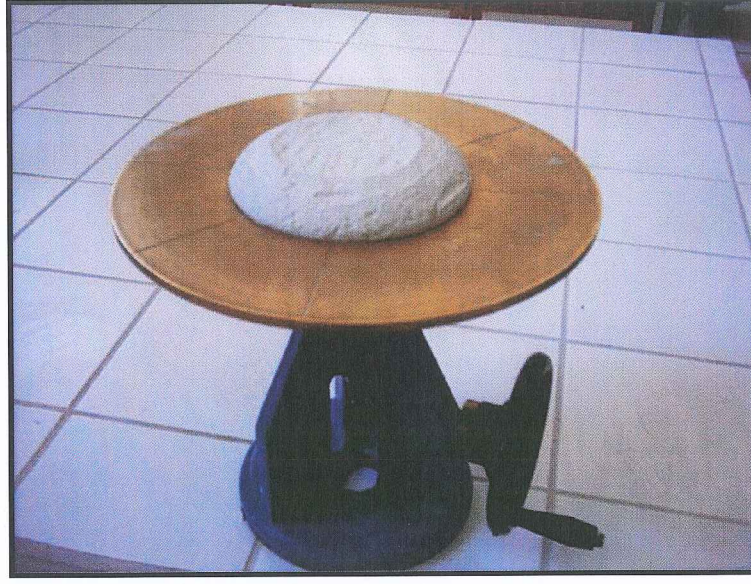
Şekil 4.2. Yayılma tablası (Flow table) metodu ile taze harcın kıvam tayini.
