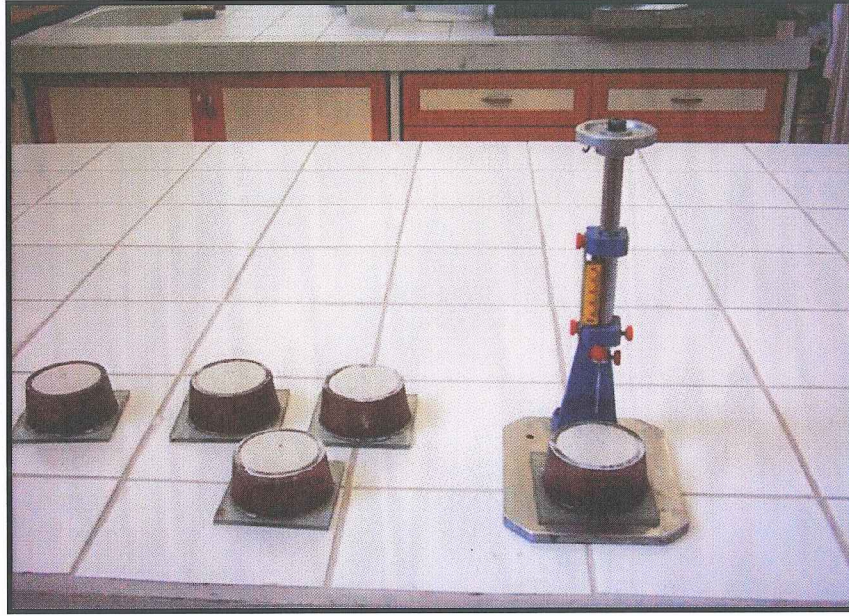
Şekil 4.10. Vicat iğnesi ile taze harcın priz ölçüm işlemi genel görünümü.
