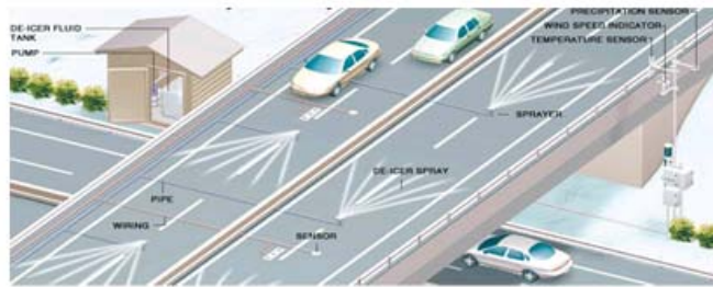
Şekil 2.22. Köprüde buzlanma önleyici sistem bileşenleri (Goodwin, 2003).
