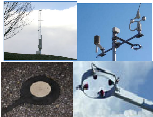
Şekil 2.19. RWIS kulesi ve sensörlerine ait örnekler
