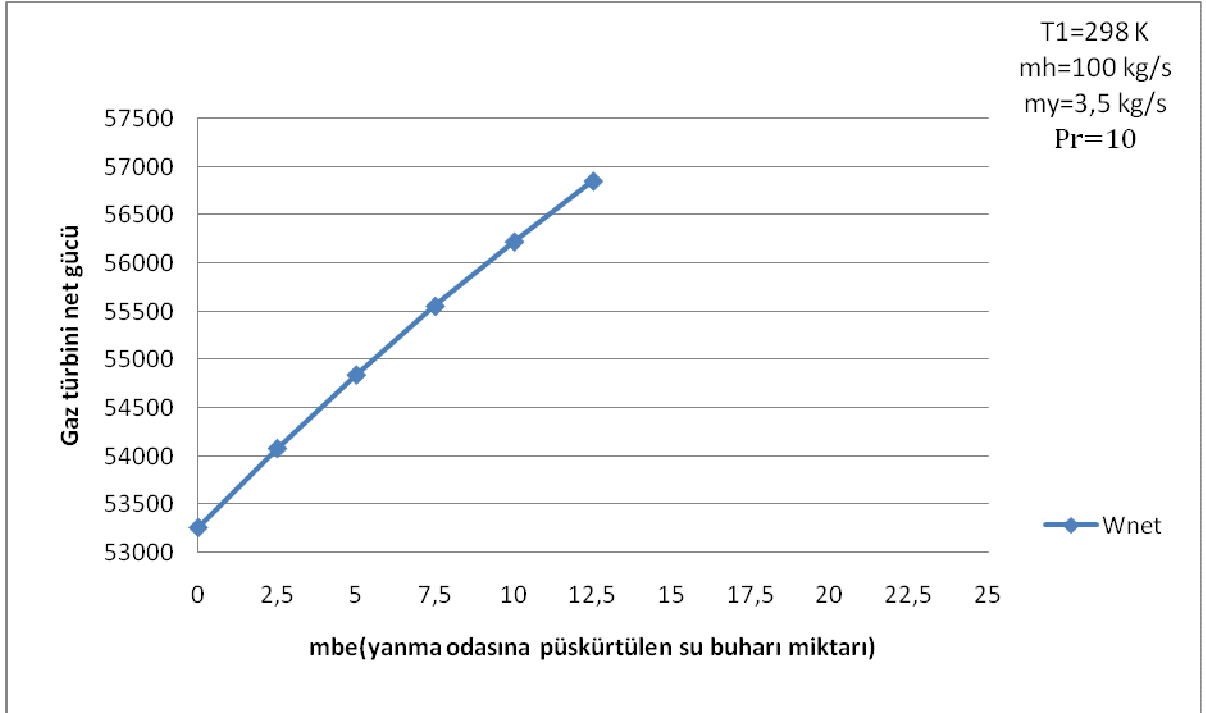
Şekil 5.5 Sabit Pr oranında yanma odasına püskürtülen buharın miktarlarına göre çevrim net gücü değerleri
