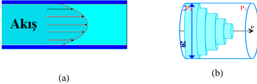
Şekil 3.15 (a),(b) İdrar borusu içerisindeki poiseuille akışta akışkan tabakaları.
