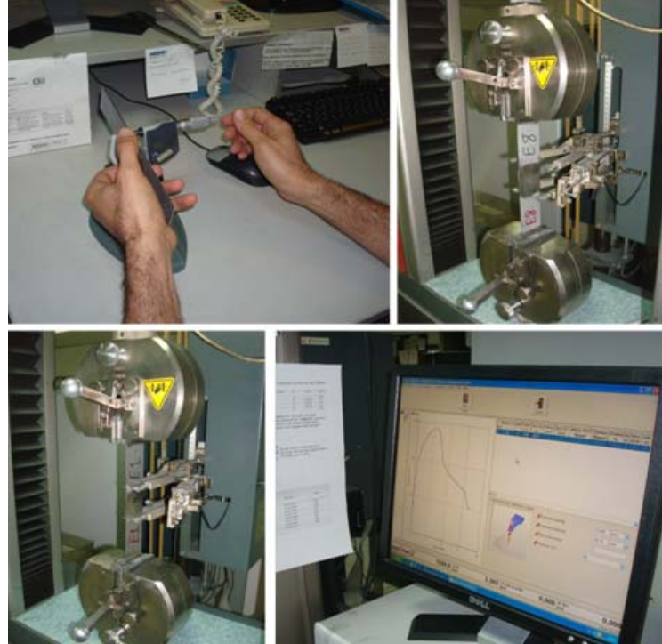
Şekil 6.29 Kaynak Numunelerine Çekme Testi Uygulanması ve Kayıtların Alınması
