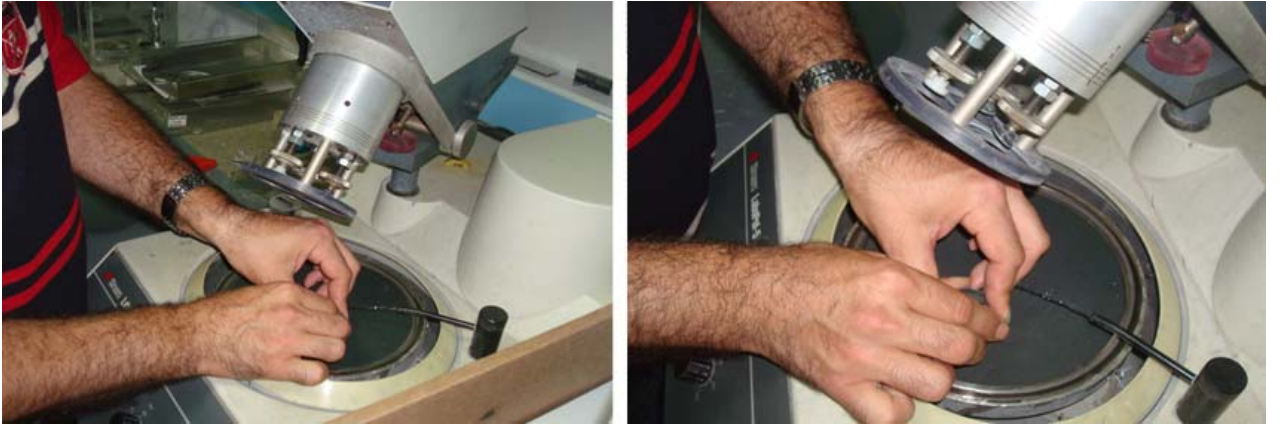
Şekil 6.34 Muayene Gruplarının Kademeli Olarak Zımparalanması
