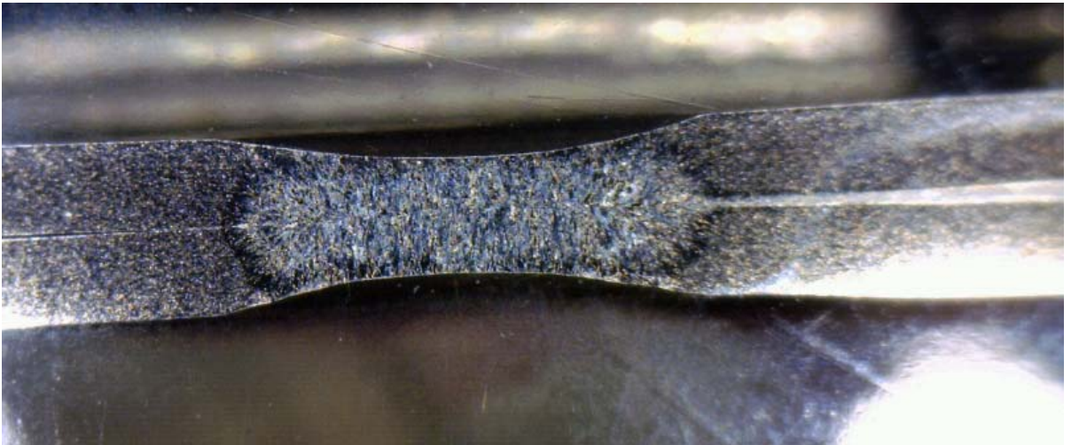
Şekil 6.77 A3 Muayene Numunesi İçin Kaynak Bağlantısı Genel Durum (40X)
