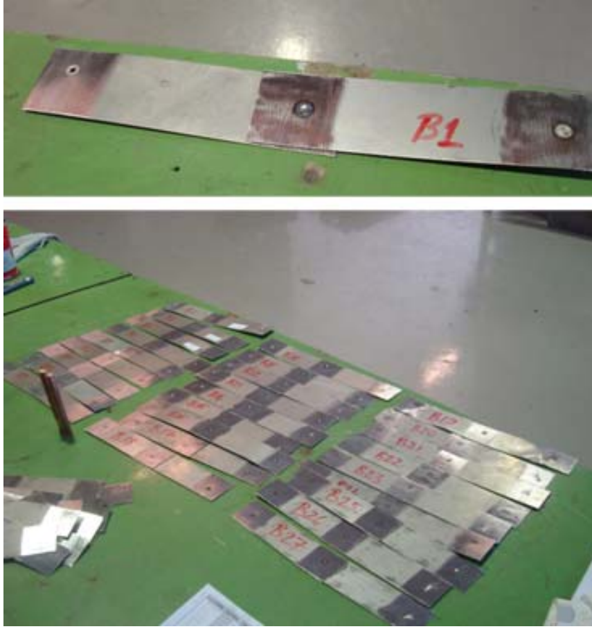
Şekil 6.17 İkinci Kaynak ve Kaynak Numunelerin İlk Serisinin Tamamlanması
