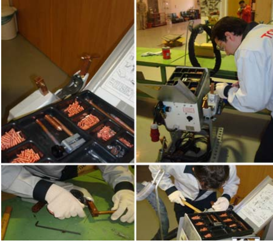
Şekil 6.12 Elektrotların Sökülmesi ve Tutucuların Kontrol Edilmesi
