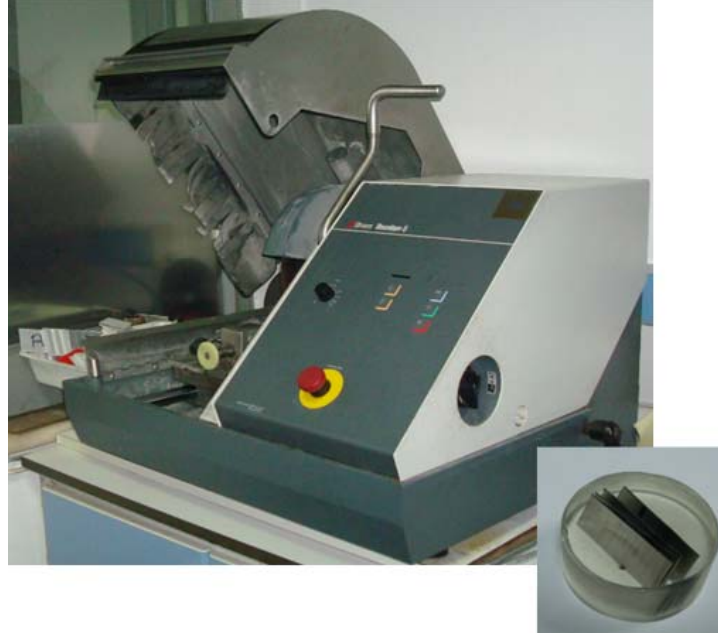
Şekil 6.33 Muayene Gruplarının Hazırlanmasında Kesme İşlemi ve Reçine İçine Gömülen Bağlantı Numuneleri
