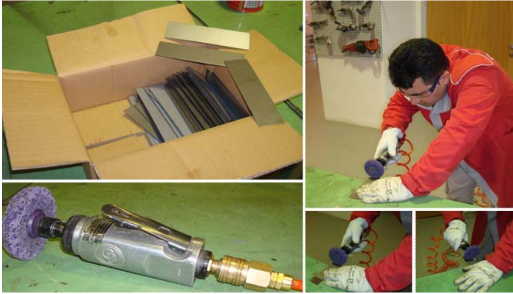
Şekil 6.11 Numune Çelik Plakaların Hazırlanması ve Kullanılan Ekipmanlar
