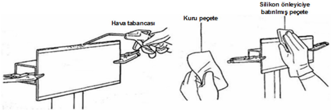
Şekil 4.8 Panel Yüzeylerinin Punta Kaynak Pastası İçin Hazırlanması(Toyota Kaporta Eğitim Kitabı, S1/B5)
