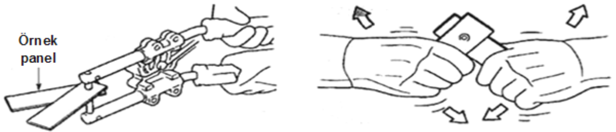
Şekil 4.15 Kaynak Şartlarının Kontrol Yöntemi(Toyota Kaporta Eğitim Kitabı, S1/B5)
