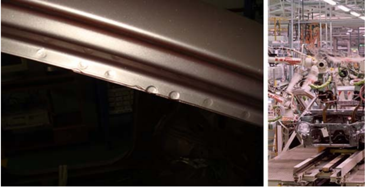
Şekil 7.1 Kaynak Robotunun Yaptığı Nokta Direnç Kaynağı ve Fabrika Ortamında Nokta Direnç Kaynak Robotu
