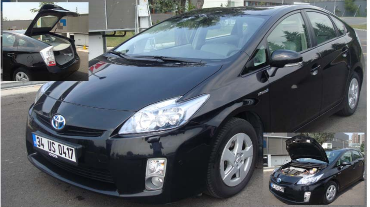
Şekil 7.2 Toyota Prius Modeli(3. Nesil) ve Alüminyumdan Yapılmış Motor Kaputu ve Bagaj Kapağı
