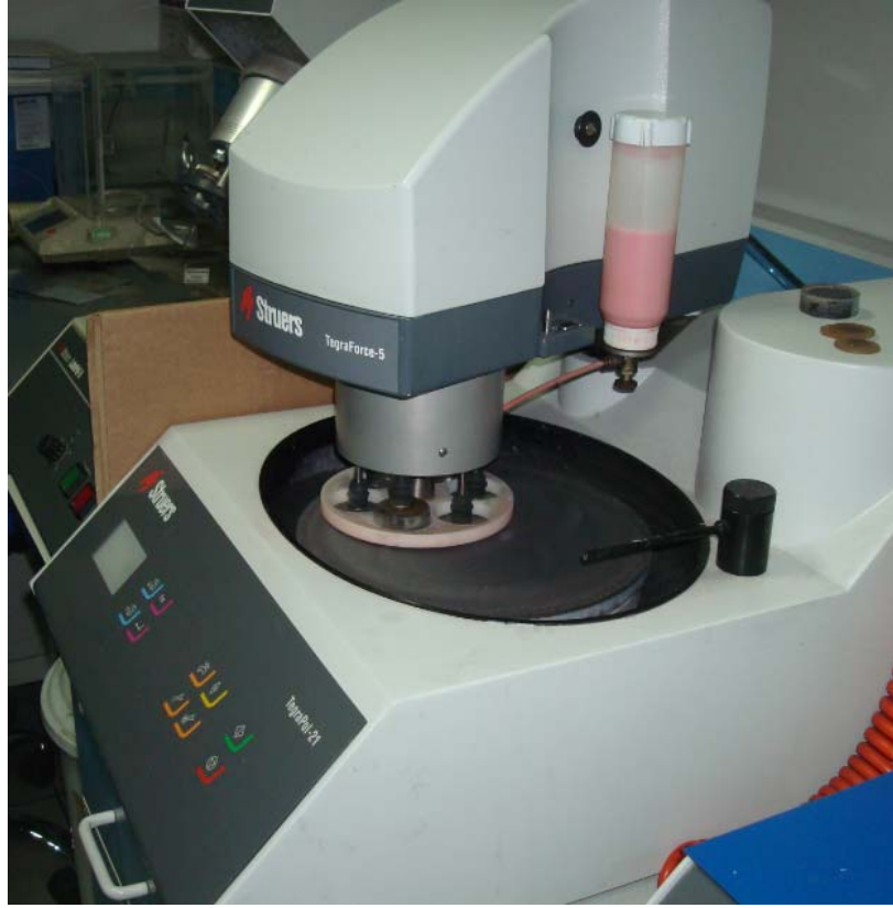
Şekil 6.36 Çuhalama İşlemi ve Otomatik Tutucu Mekanizması
