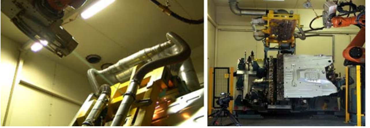
Şekil 7.3 Şasi Alt Gövdesine Lazer Nokta Kaynağı Yapılması ve Robot Ünitesi ile Kaynak Pozisyonunu Ayarlayan Fikstür Ünitesi
