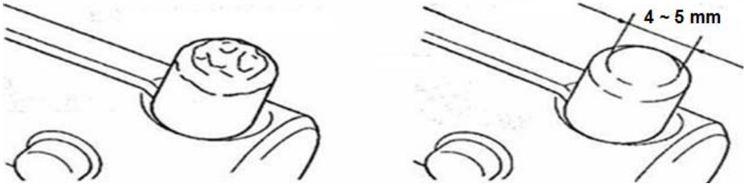
Şekil 4.13 Elektrod Uçlarının Durumu(Toyota Kaporta Eğitim Kitabı, S1/B5)
