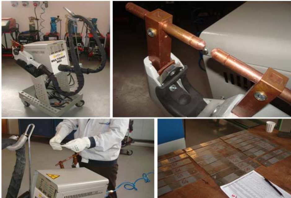
Şekil 6.21 411 Kalite Çeliklerin G Tipi Elektrot Uç Formu ile Kaynak Edilmesi
