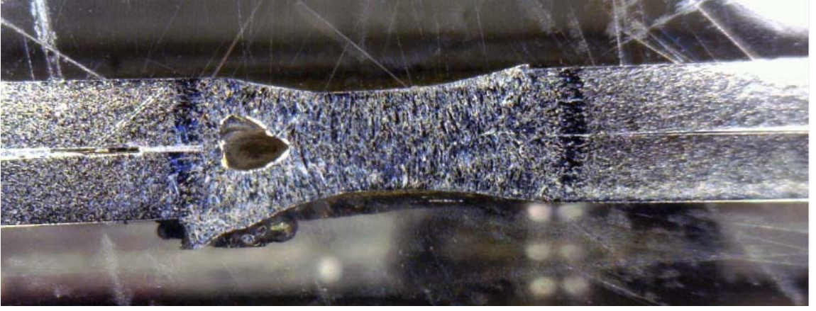
Şekil 6.78 B1 Muayene Numunesi İçin Kaynak Bağlantısı Genel Durum (40X)
