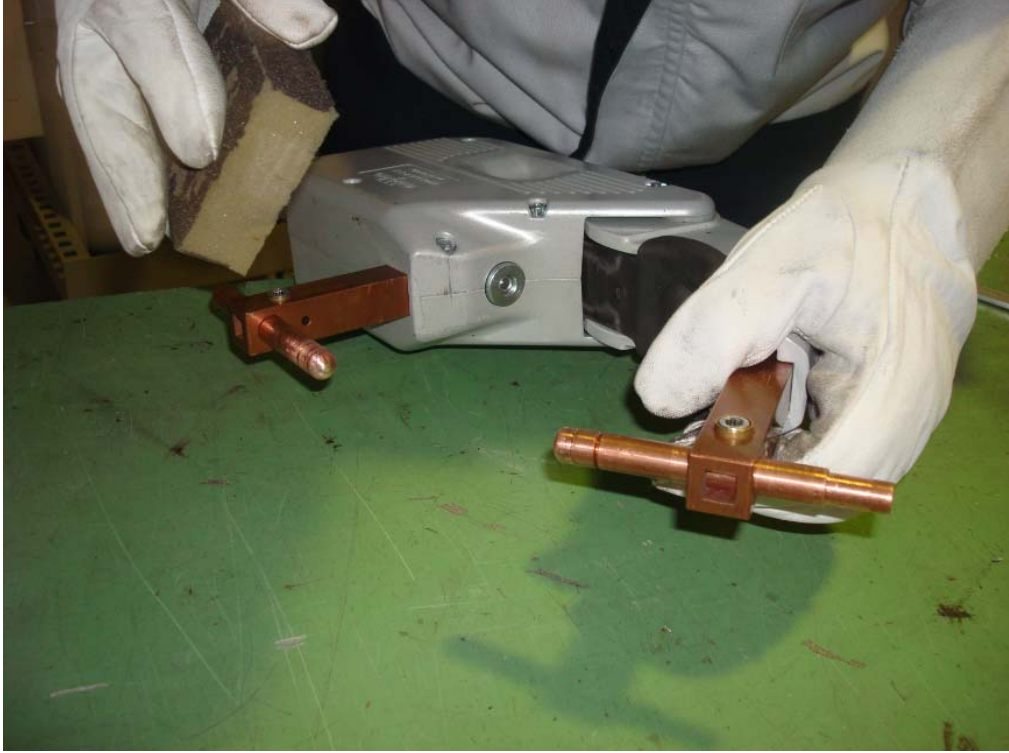
Şekil 6.19 Çeneleri Ayrılmış Pnömatik Kaynak Ünitesi ve Elektrotların Zımparalanması
