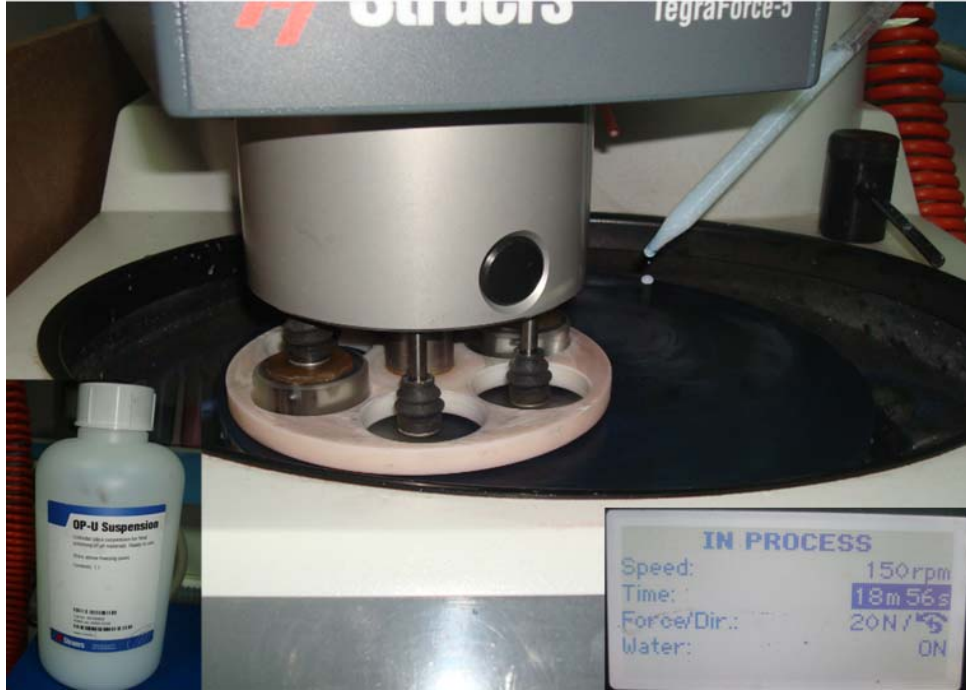
Şekil 6.37 Son Parlatma İşleminde Cihaz Ayarları ve Kullanılan Silika Süspansiyonu
