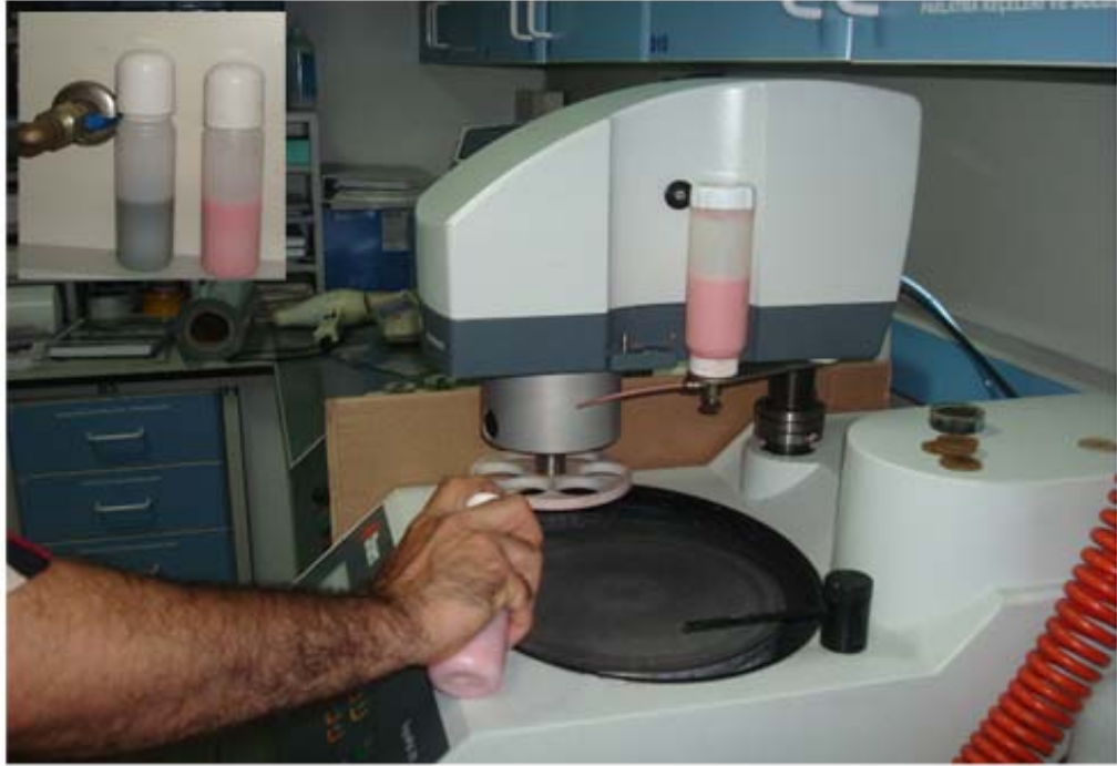
Şekil 6.35 Çuhalama İşlemi İçin Cihazın Hazırlanması
