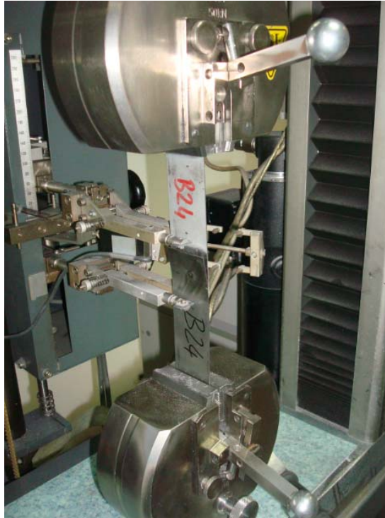
Şekil 6.31 Kaynak Numunelerine Çekme Testi Uygulanması
