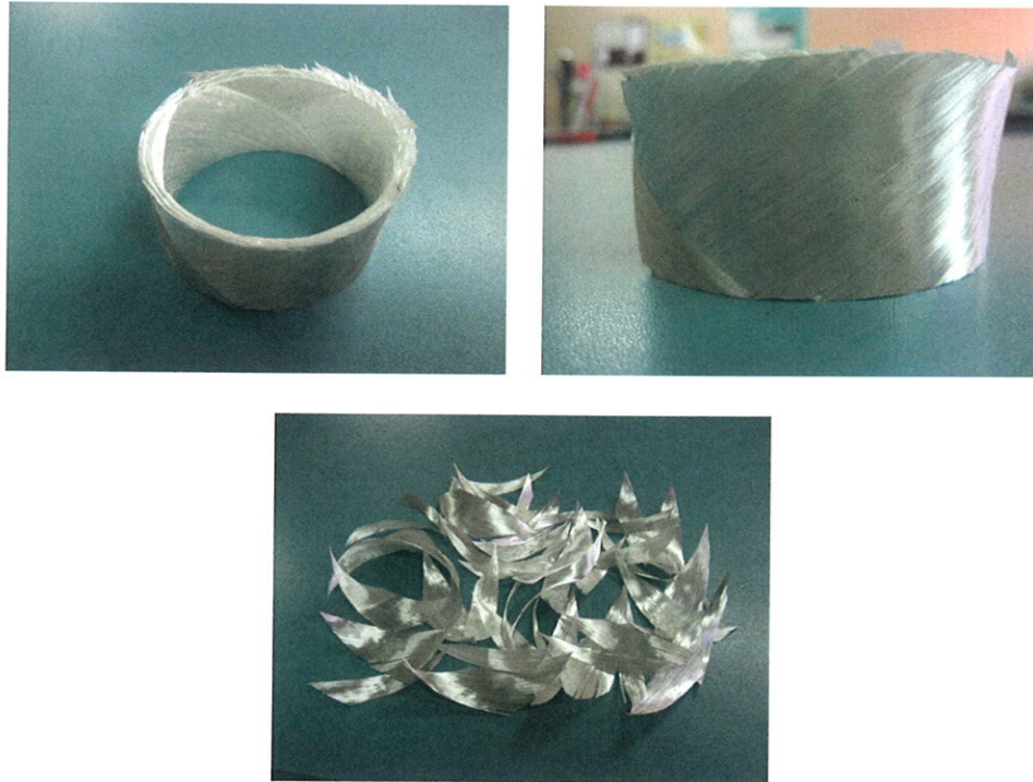
Şekil 8.1. Yakılmış deney numuneleri
