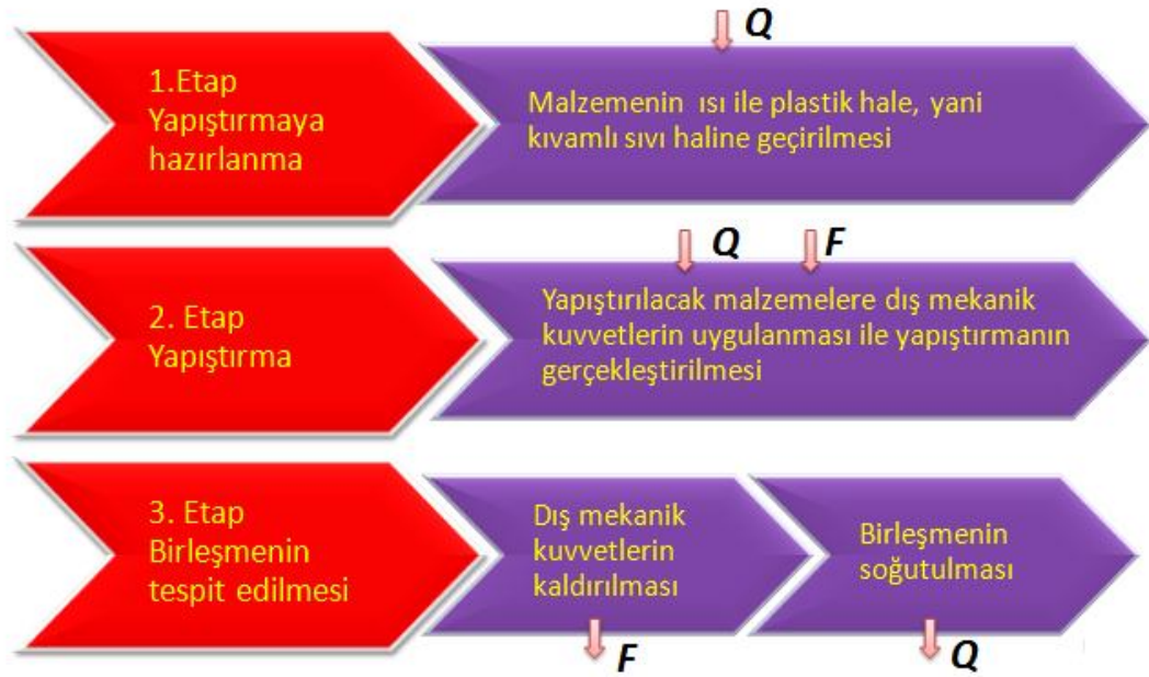
Şekil 2.13. Termoplastik yapışkan birleşmesinin oluşma mekanizması
