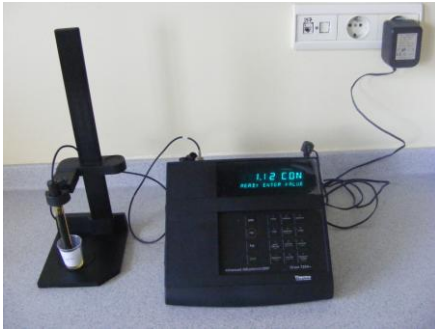
Şekil 3.2-5: Orion 720 A+ iyon analizörü ve Orion Fluorid elektrodu
