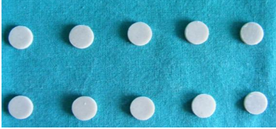
Şekil 3.2-4: Fluorid salınımı testi için hazırlanan örnekler
