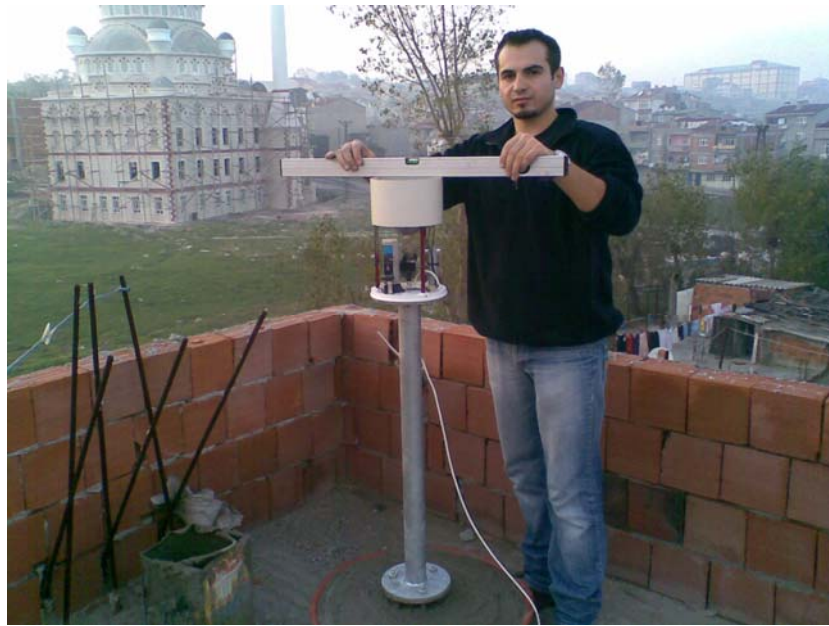
Şekil 7.6: Yağış Ölçer'in dengesinin ayarlanması
