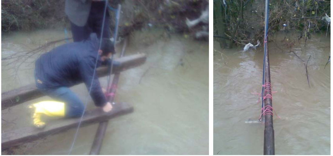
Şekil 7.7: Açık Kanal Hız Ölçer'in kurulması
