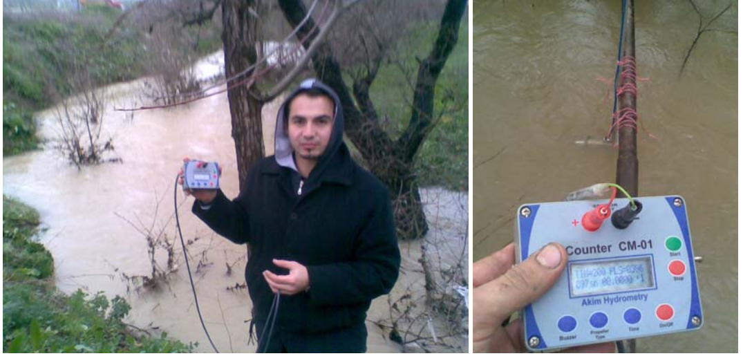
Şekil 7.9: Açık Kanal Hız Ölçer'den veri alımı
