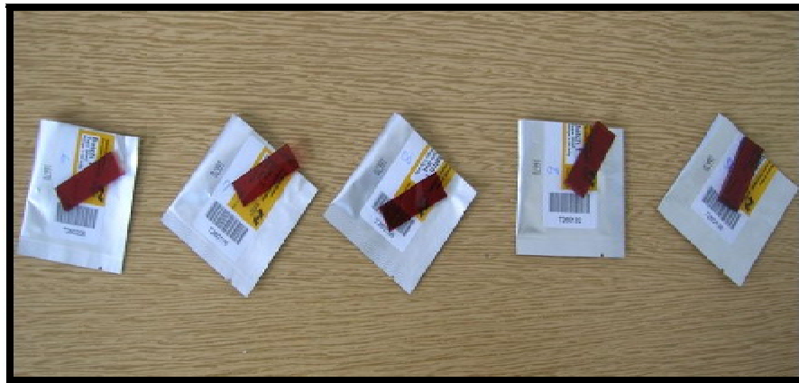
Şekil 3.2. 3042 Harwell Amber Akrilik (perspeks) (PMMA) Dozimetrelerin Genel Görünümü (Orijinal)
