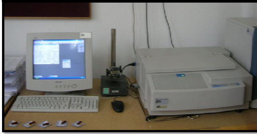
Şekil 3.3. Işınlanmış Dozimetrelerin Absorbans Değerlerinin Ölçümünde Kullanılan Spektrofotometre (UV-4 ATI-UNICAM) (Orijinal)
