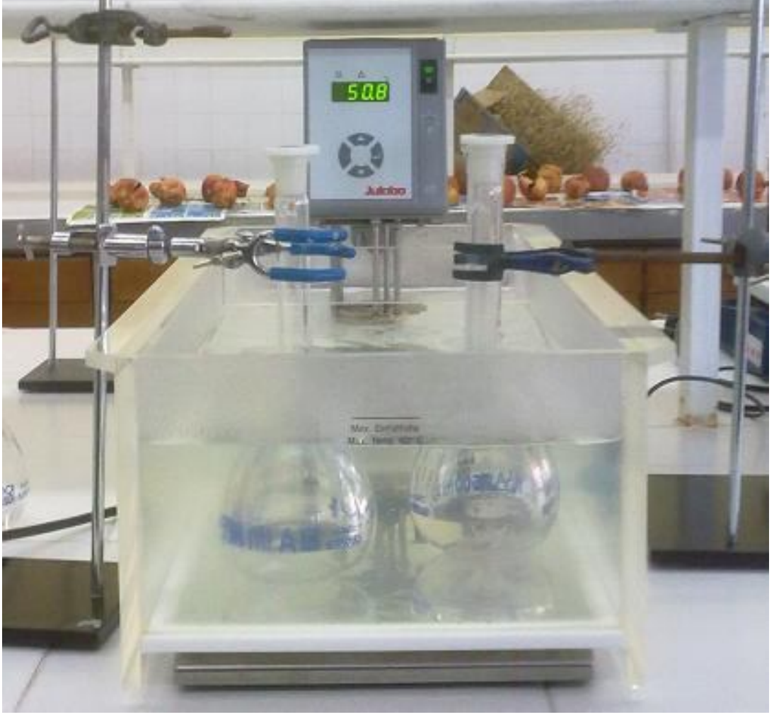
Şekil 1. 1 Su-Tuz sisteminin izotermal yöntemle araştırılması için kullanılan düzenek.
