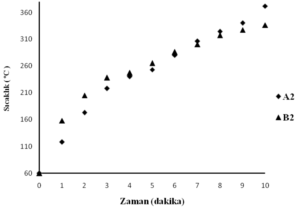
Şekil 5.28 200 N Pedal kuvvetinde A2-B2 numunelerinin disk sıcaklık değişimi
