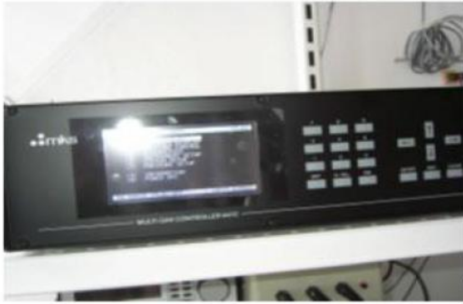
Şekil 3.5. Gaz Akış-Basınç Kontrol Sistemi
