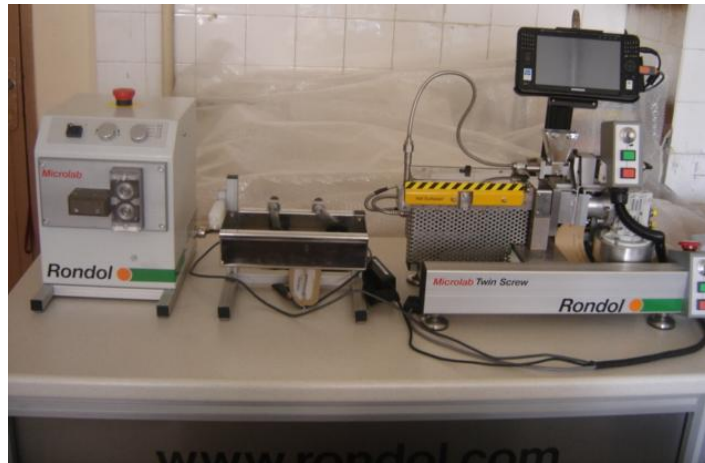
Şekil 3.2: Çift vidalı ekstruder hattı
