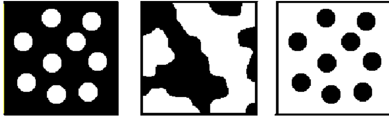
Şekil 2.3: Uyumsuz polimerlerin birbiri içinde dağılımı
