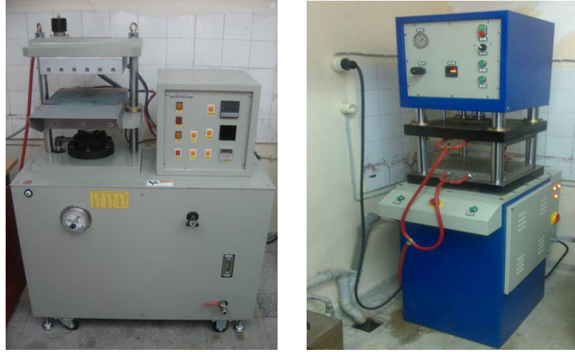
Şekil 3.4: (a) Sıcak pres (b)soğuk pres
