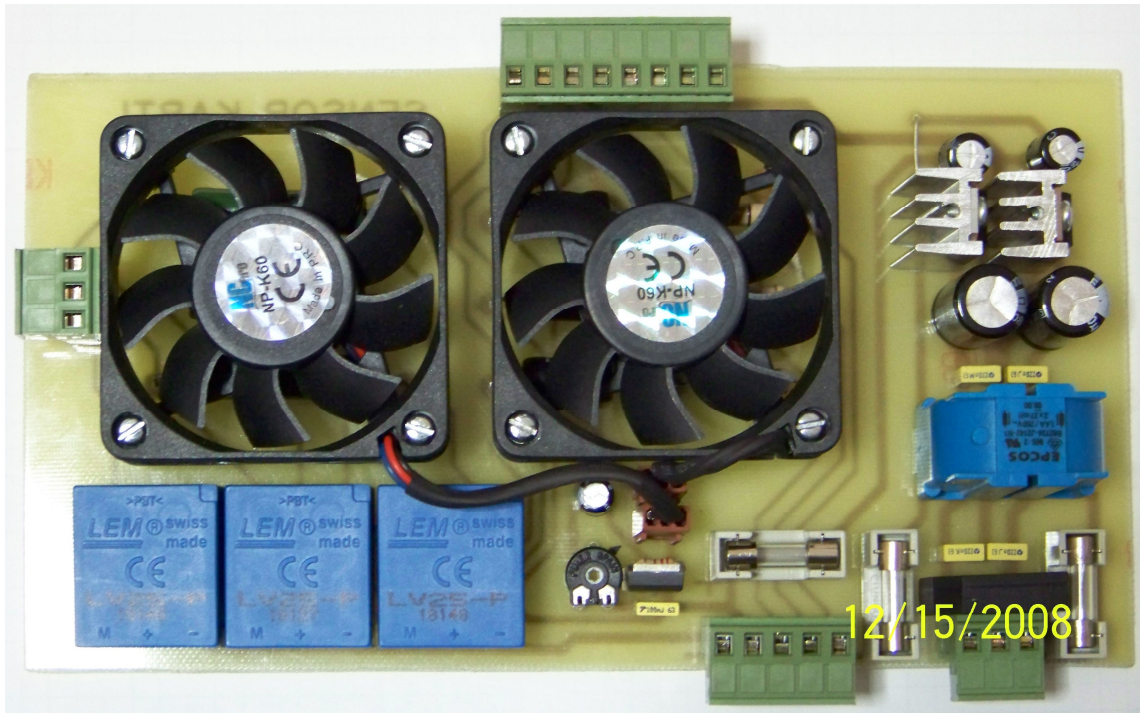
Şekil 6.4. Motor akım ve gerilimlerini okumak için yapılan sensör kartı fotoğrafı.
