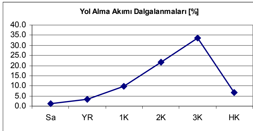
Şekil 9.13. Yol alma sürecinde arızalara göre motor akımlarındaki genelleştirilmiş dalgalanma oranları.
